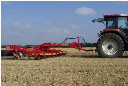
Figur 15. Billedet viser den anvendte Väderstad tallerkenharve.
