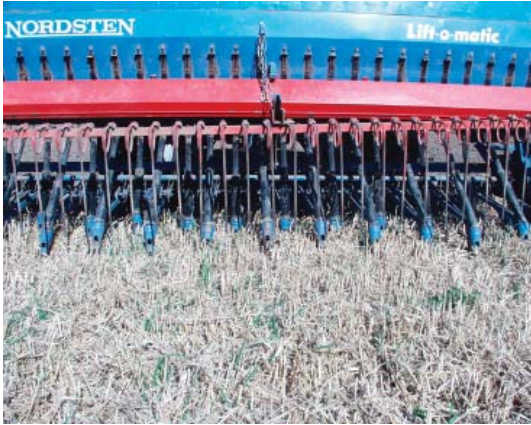
Figur 18 og 19. De to fotos viser henholdsvis den anvendte såmaskine og den anvendte spaderulleharve til etablering af den jævne udsåning.
