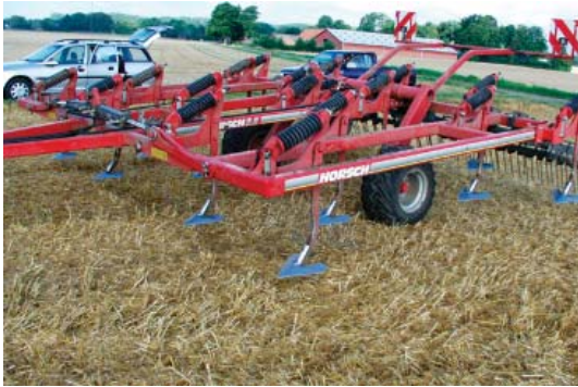
Figur 11. Billedet viser den anvendte Horsch stubharve.
