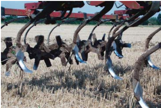
Figur 7. Billedet viser den anvendte Kongskilde stubharve.
