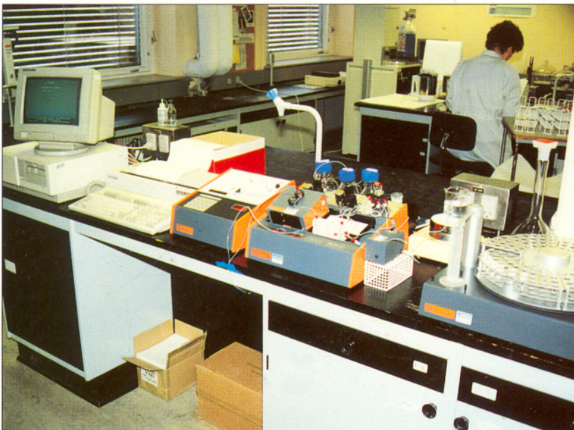
Bestemmelse af urea i mælk ved hjælp af Flow injektion analysen på Steins Laboratorium, Holstebro
