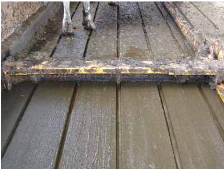
Figur 8. Skrabeanlæg til gulvtype 2.
