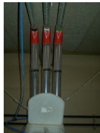
Eksempel på fasefodringsanlæg med tre rørstrenger.
