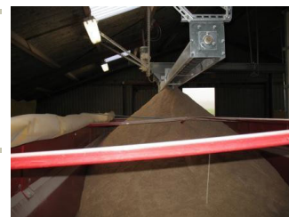
Fyldning af transportvogn med åben sneglerende
