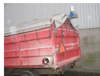
Transportvogn med tømmesnegl – vognen tippes og foderet snegles ud i bunden
