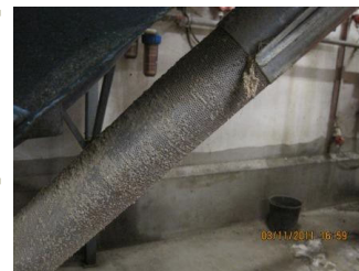
Perforeret sneglerør på korn-snegl. Fjerner delvist sand og støv (ikke halm og sten).
