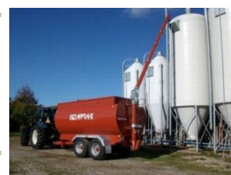
Direkte opfyldning af silo med justerbar snegl
