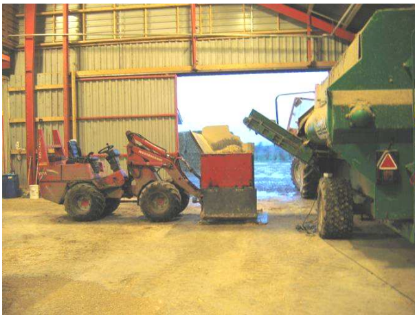
Fuldfoderet blandes i en mobil fuldfodervogn og tildeles med en ombygget "fodertruck" - der køres rundt af en minilæsser!
