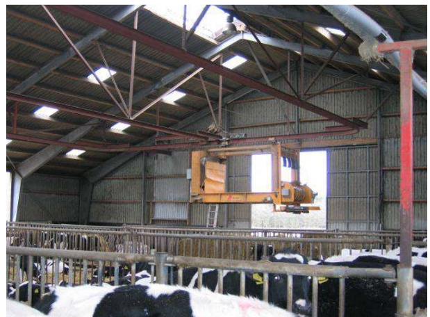
Strøelseshængebane, som strøer de dybe bokse fra 2 skinner (midterste skinne bliver fjernet).
