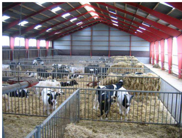
Boksene er placeret midt i stalden med en fodergang på den ene side og en strø- og drivgang i den anden.
