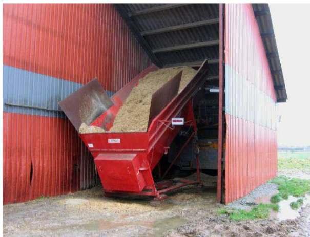
Stationer Cormall fuldfoderblander, der kombineret med en hængebane, tildeler kalvene frisk fuldfoder syv gange i døgnet.
