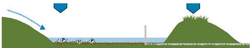
Figur 10: Illustration af en et vand- og sedimentkontrolbassin med overløbsrør fra Iowa University Extension and Outreach.
