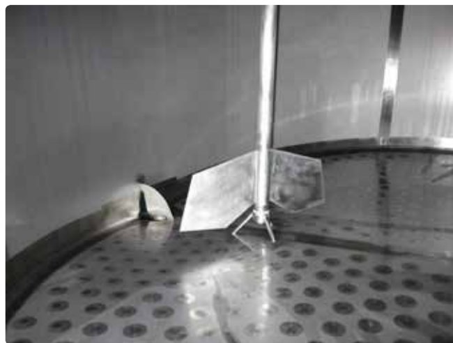
Fig. 5. Omrører i stående mælkekøletank, vortex sikring.
