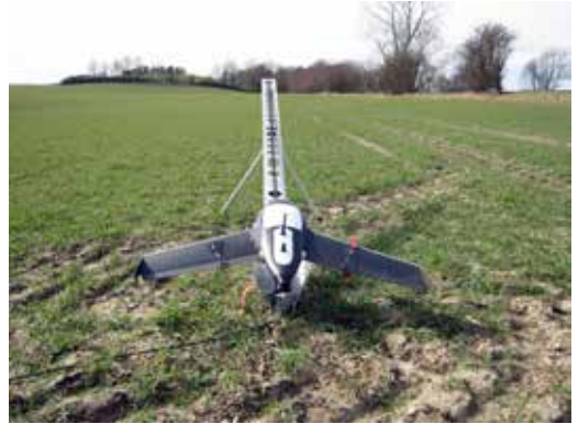
Den anvendte drone er en fastvinget drone af mærket Trimble UX5 med et SONY NEX-5R kamera. (Foto: Rita Hørfarter, Videncentret for Landbrug).
