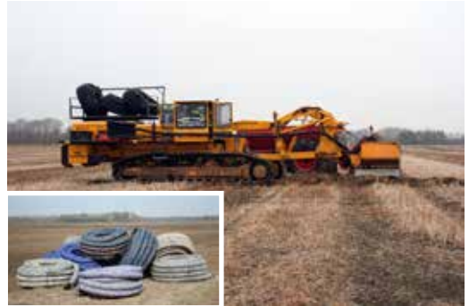
I forsøget med dræning på finsandet jord afprøves forskellige metoder og materialer til dræning. (Fotos: Janne Aalborg Nielsen, Videncentret for Landbrug).
