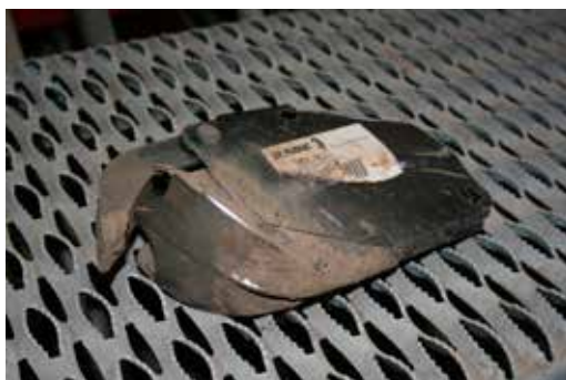
Billede af vingeskær, der deler sårækken i to spor med en afstand på cirka 5 cm. Såskærets flade bund forhindrer, at frøene sås for dybt. (Foto: Henning Sjørsløv Lyngvig, Videncentret for Landbrug).
