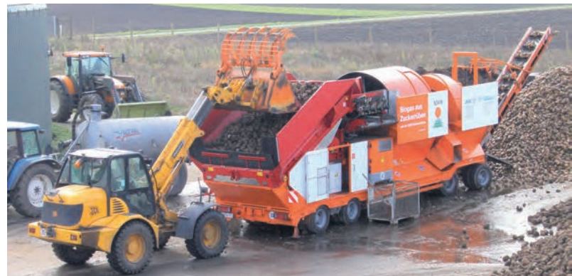
KWS har, som førende forædler inden for sukkerroe, deltaget aktivt i udviklingen af en roevasker med stenfraserter, som i dag turer rundt i Tyskland og foretager roevask for biogasanlæg.
