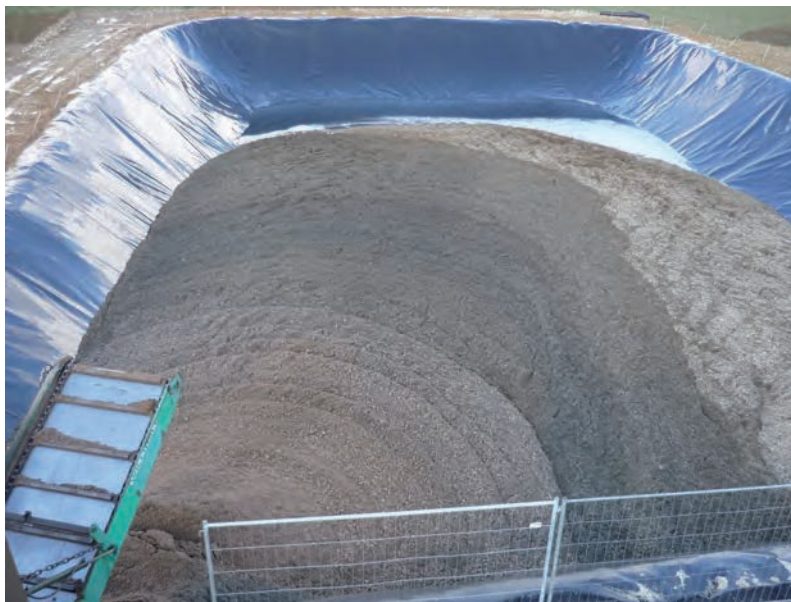
Laguneensilering af snittede roer, som udmærkes ved at være delvis flydende. Dette sikrer en lettere transport fra lager til reaktor.
