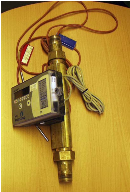
Figur 4.13. Kamstrup varmemåler, type 66C, nominelt flow på 6 m 3 pr. h, 260 mm x 5/4".
