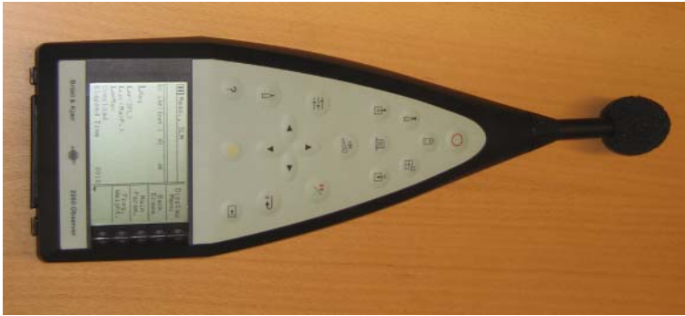
Figur 4.14. Lydmåler type 2260 fra Brüel & Kjær.
