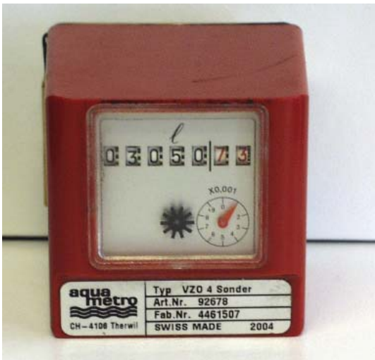
Figur 4.12. Dieseloliemåler VZO 4 anvendt på minikraftvarmeanlæg fra EC Power.
