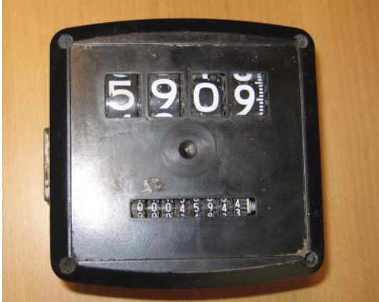
Figur 4.10. Dieseloliemåler K 44 anvendt på minikraftvarmeanlæg fra KVA Diesel.
