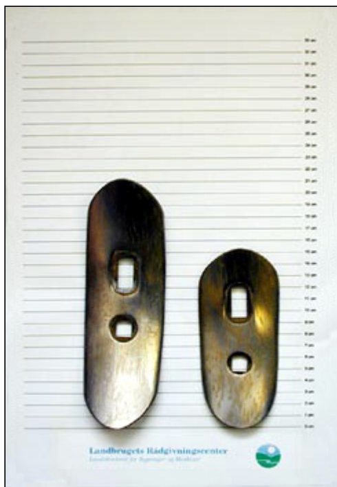
Figur 8. Billede af de brugte Kverneland og Solbjerg spidser efter 70 + 44 ha. Den mindste er Kverneland.
