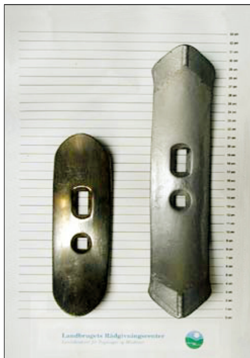
Figur 5. Brugt og ny Solbjerg spids til Kverneland Turbo II.
