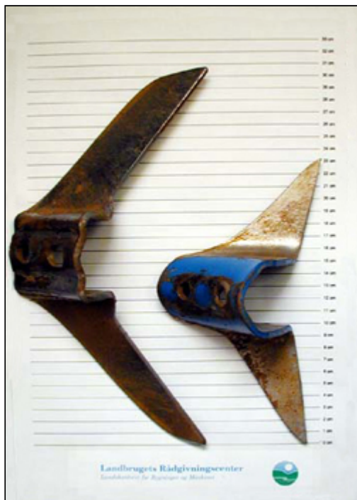
Figur 10. Billede af de brugte Solbjerg og Kongskilde vingskær efter 70 ha. Den mindste er Kongskilde.
