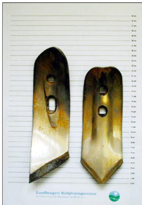
Figur 9. Billede af de brugte Kongskilde og Solbjerg spidser efter 70 ha.
