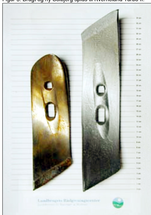
Figur 7. Brugt og ny Solbjerg spids til Kongskilde VibroFlex.
