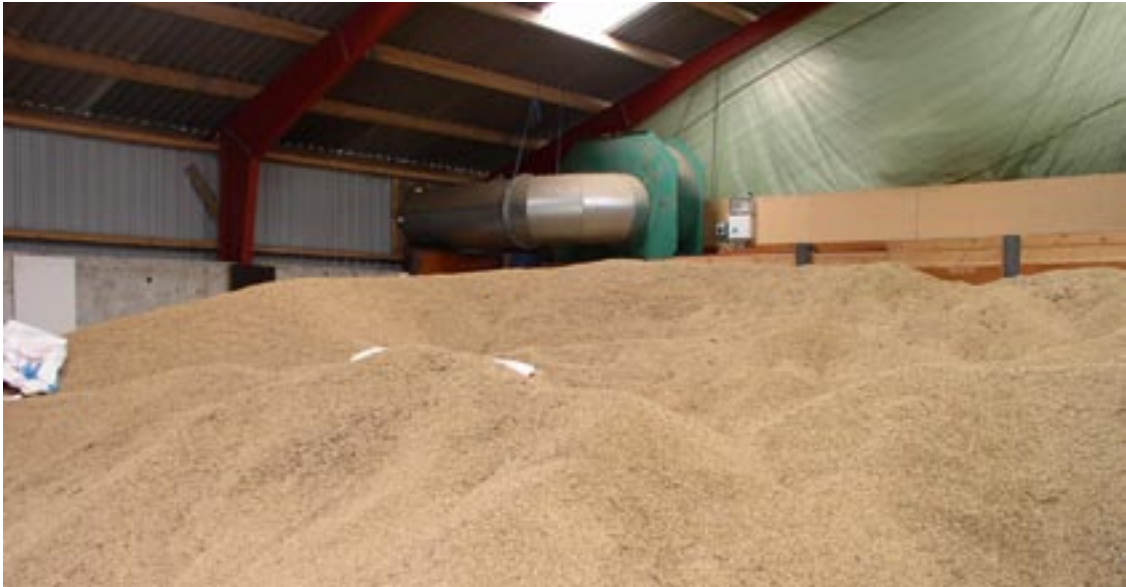
Figur 4.16. Lagertørringssilo, hvor blæser helt korrekt suger luft udefra.
