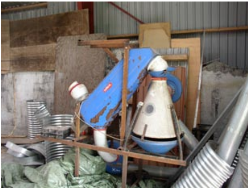
Figur 4.7. Forrener med påbygget snegl og frøsold.
