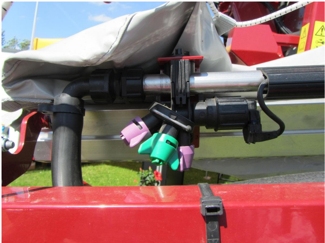
Billede 2. Recirkuleret rørføring med el-aktiveret dysse.
