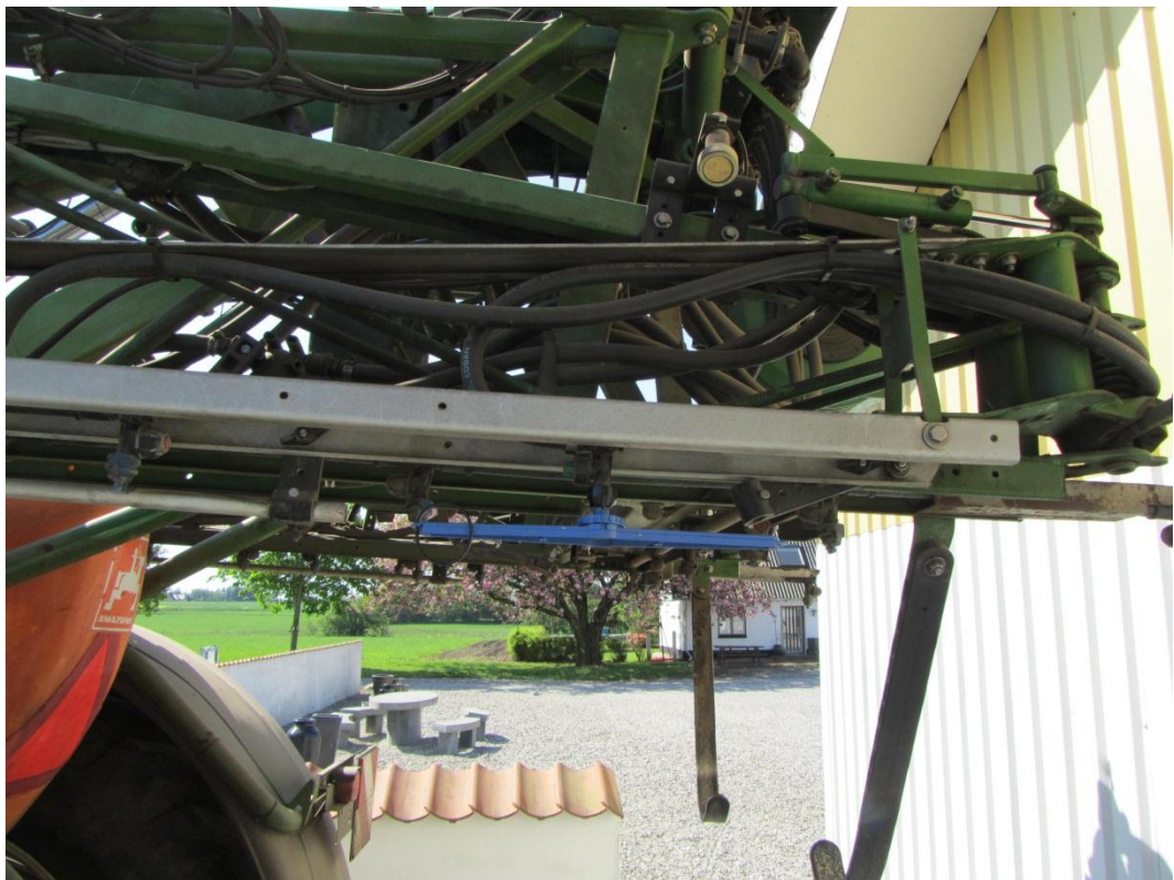
Billede 11. Billericay Autostreamer gødningsdyser, også kaldet drible-rør.
