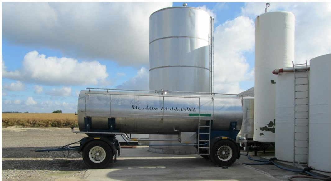
Billede 5. Lastbilhænger genbrugt til flydende gødning.
