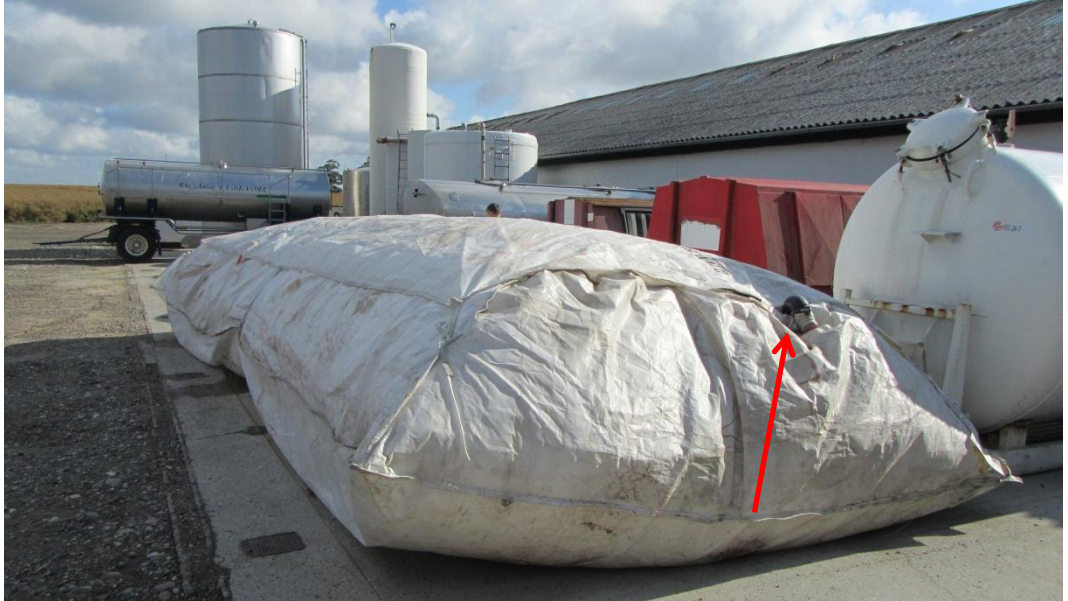
Billede 6. Storpose til 34 tons. Bemærk 3" tømmestuds (markeret med pil).
