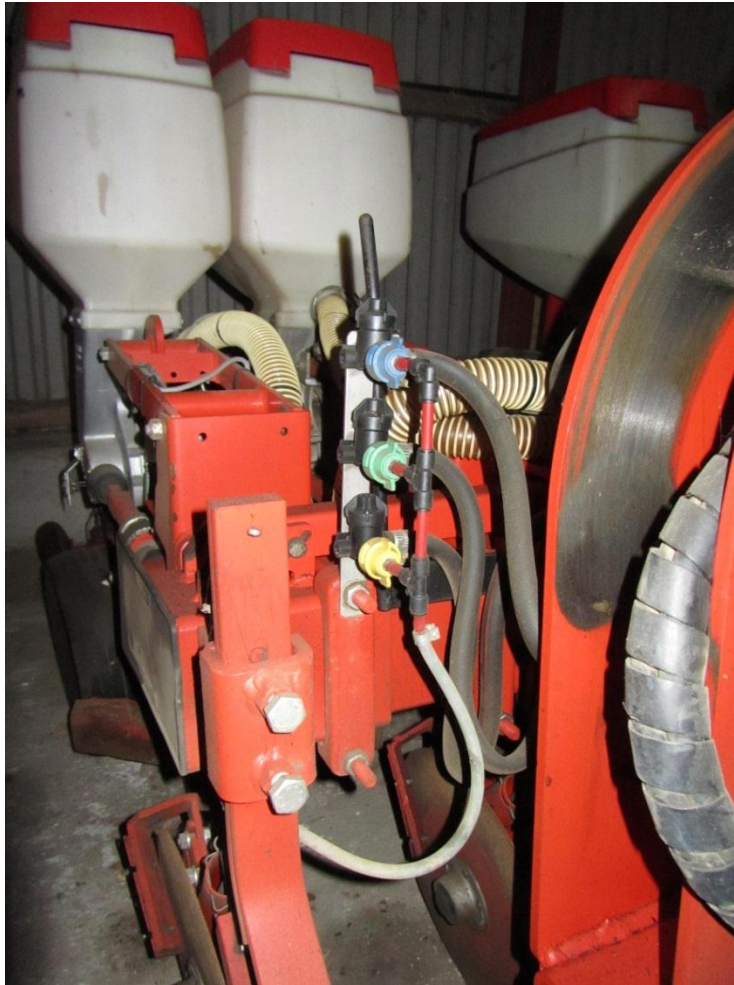
Billede 9. Dysepladen er monteret i afgangen til hver af de tre slanger.
