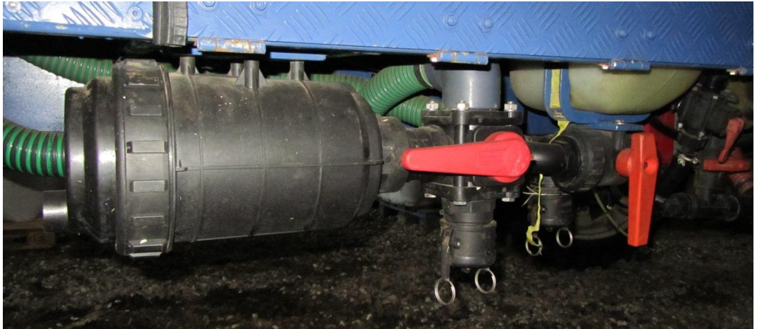
Billede 8. Fyldefilter monteret på sprøjten.
