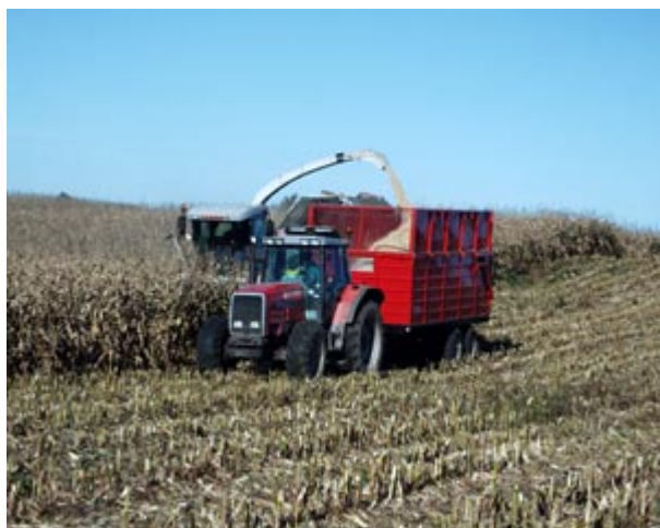
Kolbehøst af majs med selvkørende finsnitter
