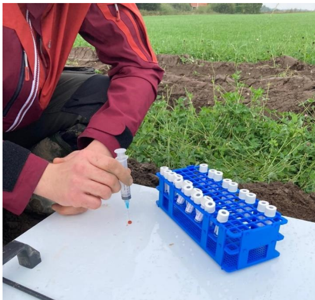
Figur 7 Her ses gasprøvetagning med sprøjte og nål fra et lukket kammer.
