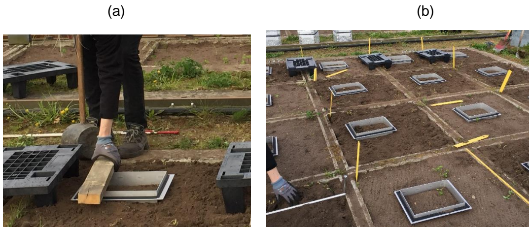
Figur 4 Rammer sat i jorden før prøvetagning. a) Rammerne sættes i jorden ved at hamre på en flad trælægte, b) Opsatte rammer.
