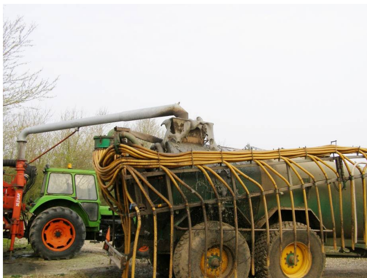
Figur 6. Med separat pumpe er det vanskeligt at fylde vognen helt op på grund af skum. Foto: Jens J. Høy, AgroTech.
