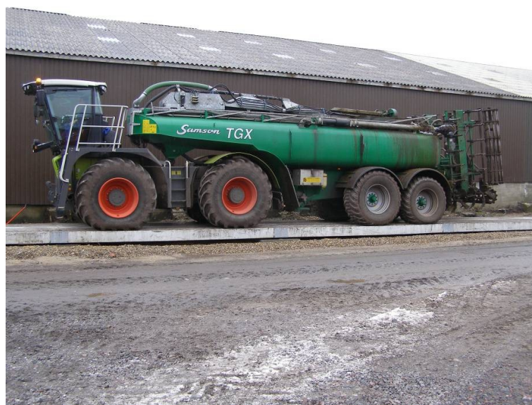
Figur 2. Gyllevognen vejes på brovægt både før og efter spredning. Foto: Jens J. Høy, AgroTech.
