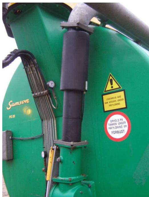
Figur 3. Eksempel på magnetisk flowmåler og hydraulisk trevejsventil til regulering af doseringen. Foto: Jens J. Høy, AgroTech.
