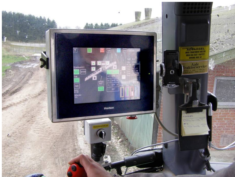
Figur 5. Vognens funktioner og dosering kan styres og følges på en skærm. Foto: Jens J. Høy, AgroTech.
