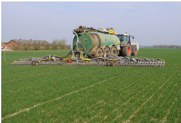
Figur 1. For at kunne måle og dosere gyllen korrekt, er det en stor hjælp med en elektronisk flowmåler på vognene. Foto: Jens J. Høy, AgroTech.
