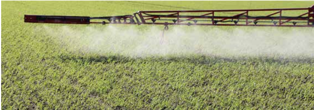
Fladsprededyse ISO 03 giver mange små vindfølsomme dråber.
