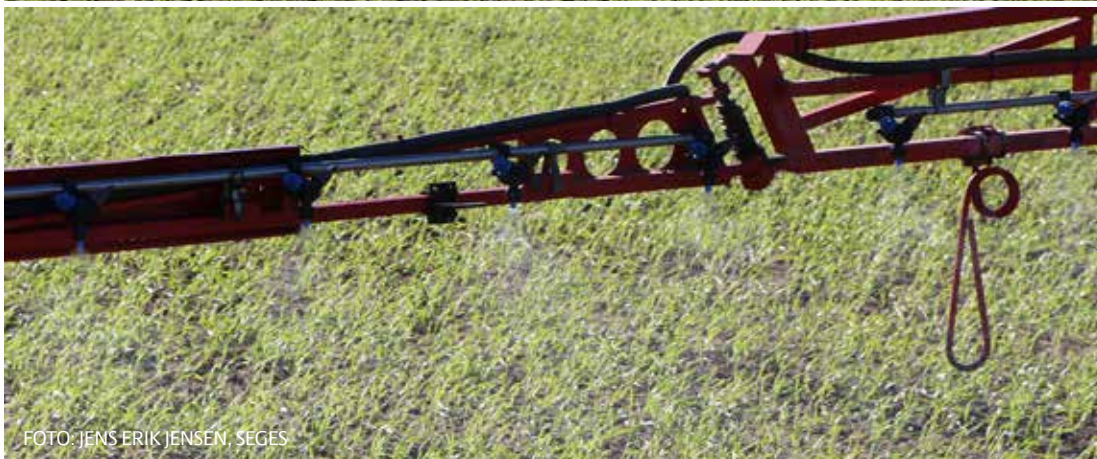
Kompaktluftinjektionsdyse ISO 03 giver 90 procent reduktion af afdrift.
