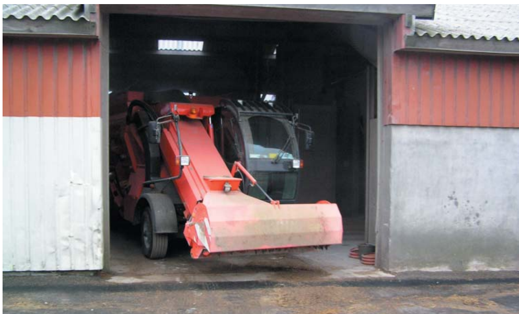
Figur 6.4 Der skulle læsses 3 forskellige fodermidler i denne lade, men pga. den manglende plads, var maskinen nødt til at skulle ud af laden efter at have læsset 2 fodermidler for derefter at bakke ind igen og læsse det sidste fodermiddel.
