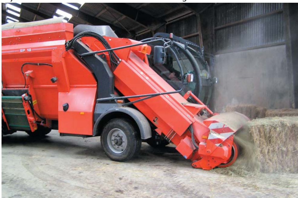
Figur 4.10 Kuhn SP 18 læsser hø fra mini bigballe.
