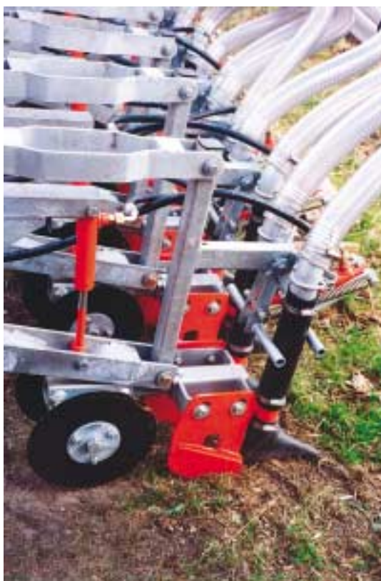
Figur 16. Kaweco nedfælder med 18 cm skærafstand.
