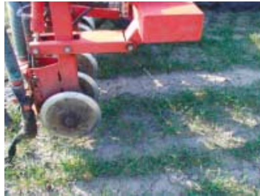
Figur 11. JL 310 nedfælder, som danner V-formet render i jorden.
