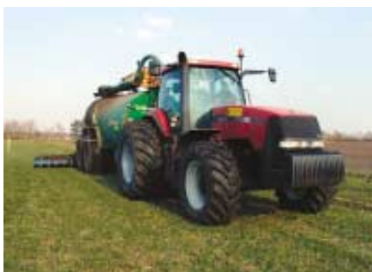
Figur 25. Nedfældning af gylle med Kimadan nedfælder.
