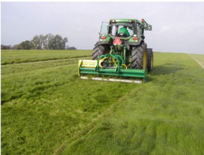
Slagleafpudser med små slagler: Spearhead Q 2800 HD.
