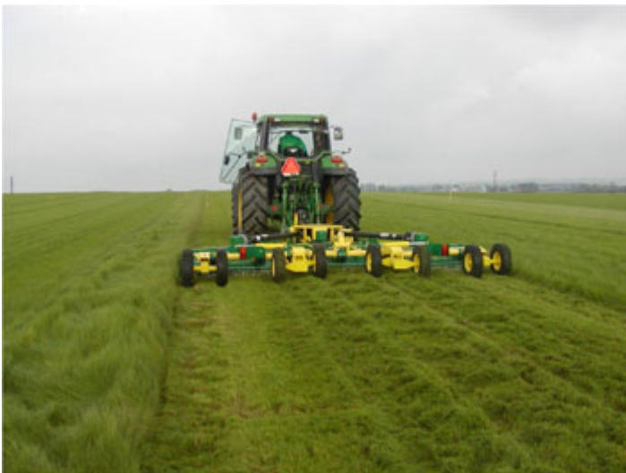
Rotorafpudser: Spearhead 460 Multi Cut. Knivene og slaglerne var nye.
