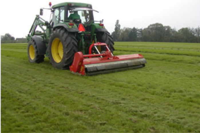
Slagleafpudser med store slagler: Kuhn VKM 305 med hammerslagler.
