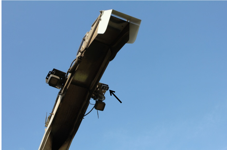
Billede 4. Analogt kamera fra Alulette Vision monteret på Jaguar finsnitter.
