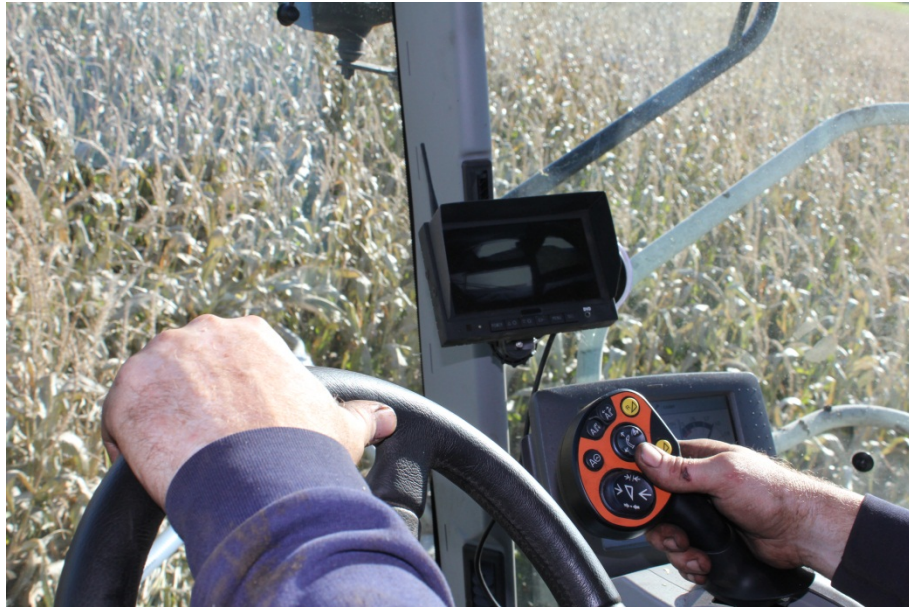
Billede 10. Monitoren monteret på sideruden med sugekop.
