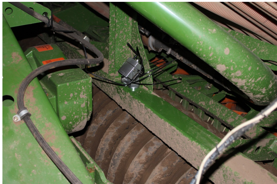
Billede 8. Digitalt kamera fra Alulette Vision monteret på rotorharve til overvågning af rotorerne.
