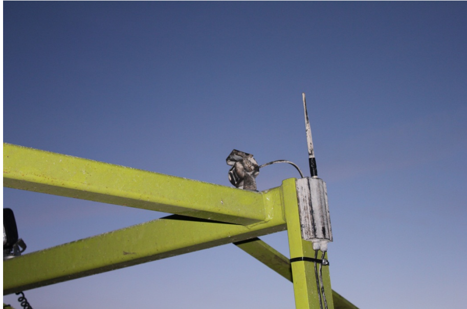
Billede 11. Kamera og sender monteret på presser.
