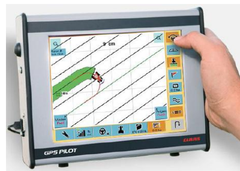
Billede 17. 8,4" skærm til GPS Pilot S3.
