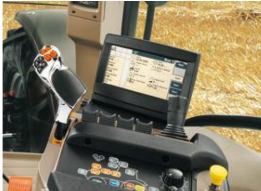
Billede 18. AFS Pro-300, 7" monitor. Integreret på visse Case IH traktorer.
