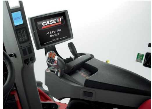
Billede 19. AFS Pro-700, 12,2" monitor. Integreret på visse traktorer og mejetærskere.
