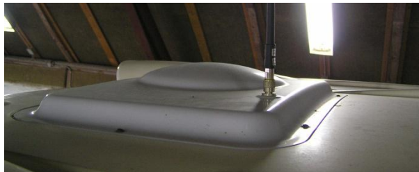
Billede 29. GPS antenne og gyroer indbygget i taglemmen.
