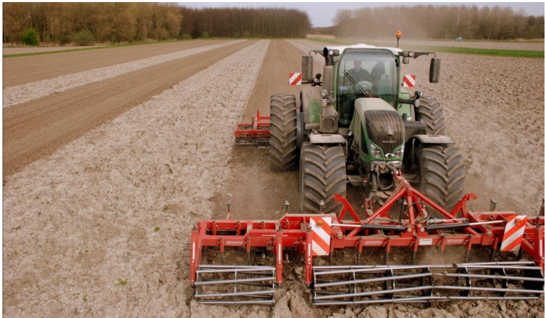
Billede 3. Nøjagtig styring af hvert andet træk. Foto: SBGuidance.
