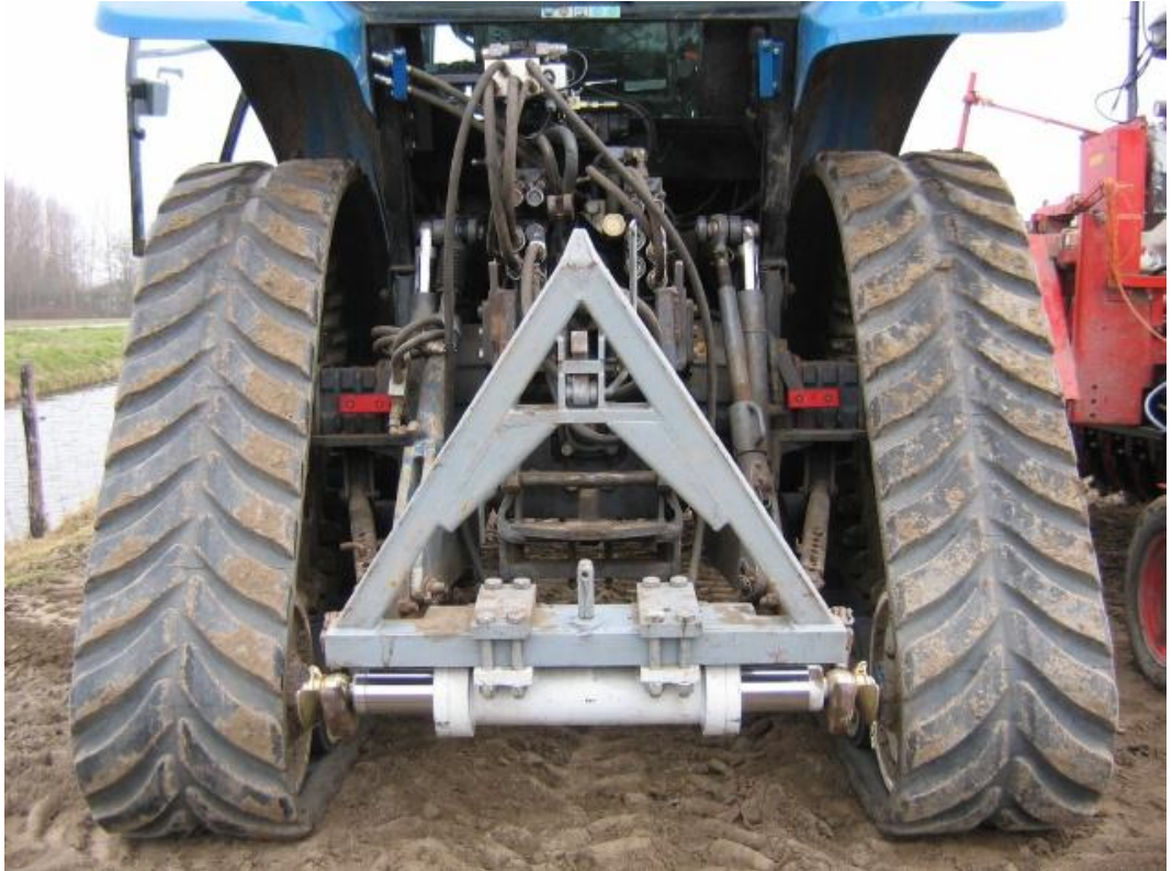
Billede 4. A-ramme til styring af et redskab ved hjælp af sideforskydning. Foto: SBGuidance.
