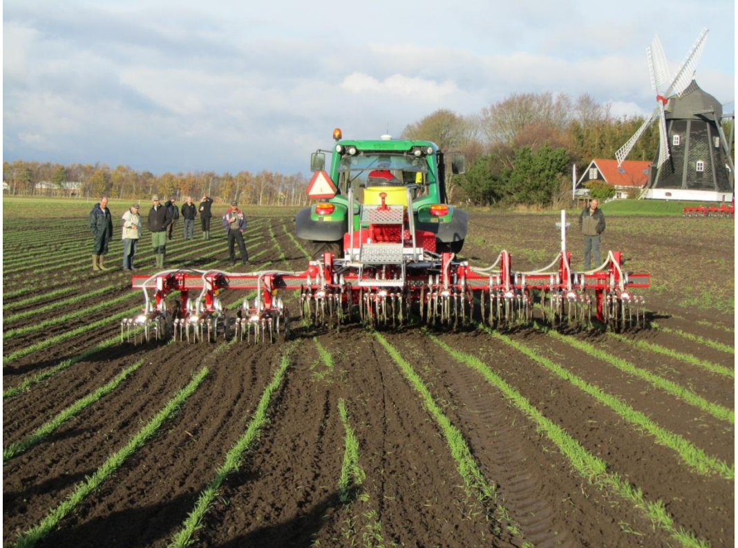
Billede 7. GPS styring af hver enkelt tandrække på radrenser.
