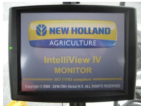
Billede 23. IntelliView IV, 12,2" monitor. Integreret på CR mejetærskere og FR finsnitte.
