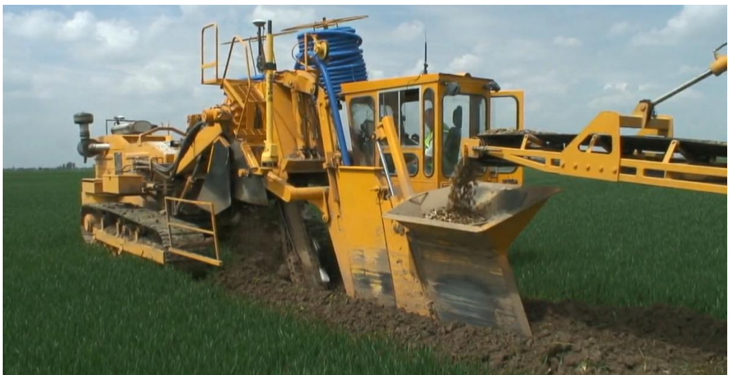
Billede 5. Drænplov med dybdestyring via GPS. Foto: GEOTeam.
