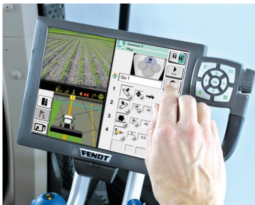
Billede 30. 10,4" terminal for VarioGuide.
