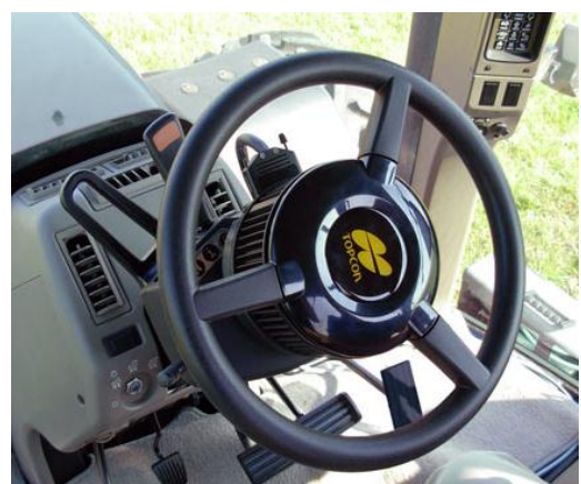
Billede 42. AES-25 el drevet rat til eftermontage.
