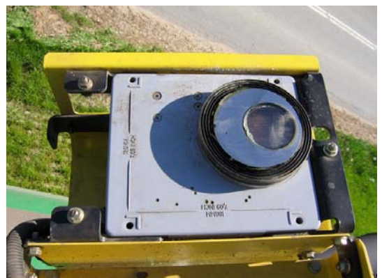
Figur 7. Indvendige side af NIR-sensor vippet ud.
