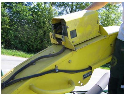
Figur 6. NIR-sensor på John Deere finsnitter.
