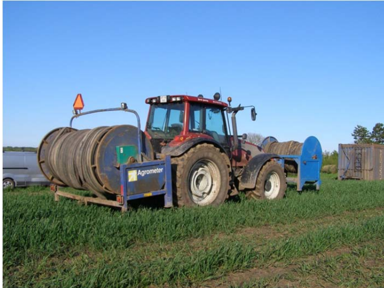
Figur 7. Fødeslanger på front og bagmonteret tromle uden ribber.
