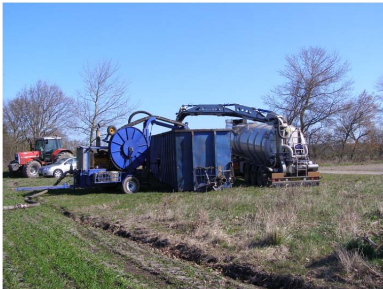
Figur 1. Pumpe ved buffertank, der fyldes med lastvogn.
