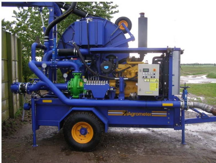
Figur 3. Pumpe, der pumper direkte fra gyllebeholder til maskine.
