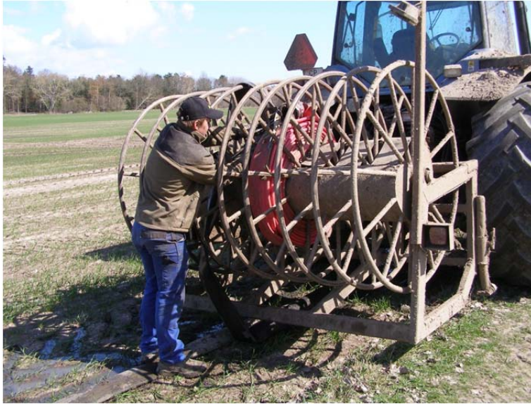
Figur 5. Slangestykkerne monteres enkeltvist på slangetromlen
