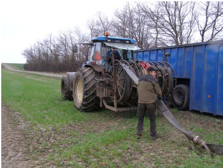
Figur 6. Fødeslangerne samles med "Storz"-koblinger for hver 100 m.
