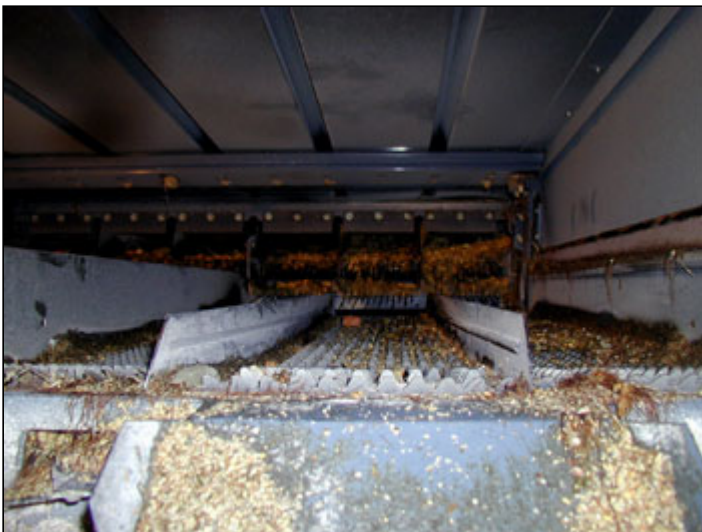
Billede 2. Soldene i mejetærskeren er klistret til af våde majs.
