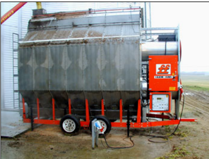
Billede 4. Bemærk: kondensvand på ydersiden af tørreriet.
