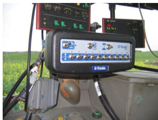
Det er computeren i boksen EZ boom, der beregner, hvor der skal lukkes for sektioner.
