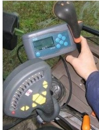
Ændringer af bredde på de enkelte sektioner overføres automatisk til AS 7500 computeren. En sektion kan være ned til en dyse bred.
