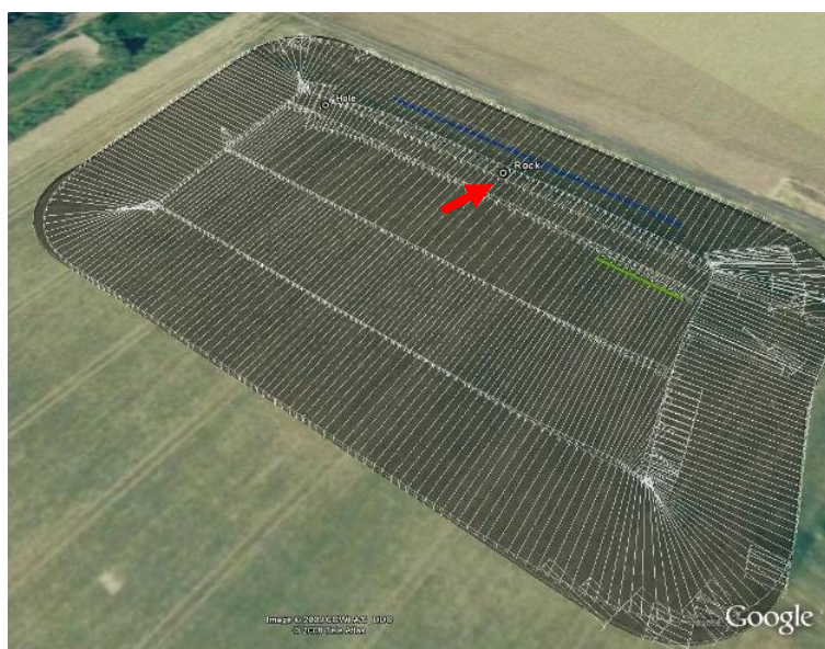
Billedet her viser resultatet af logning af en kørsel med AgGPS Field Manager fra Trimble. Ved den røde pil, er afsat en markering under kørslen. (Kortet er genereret i Google Maps.)
