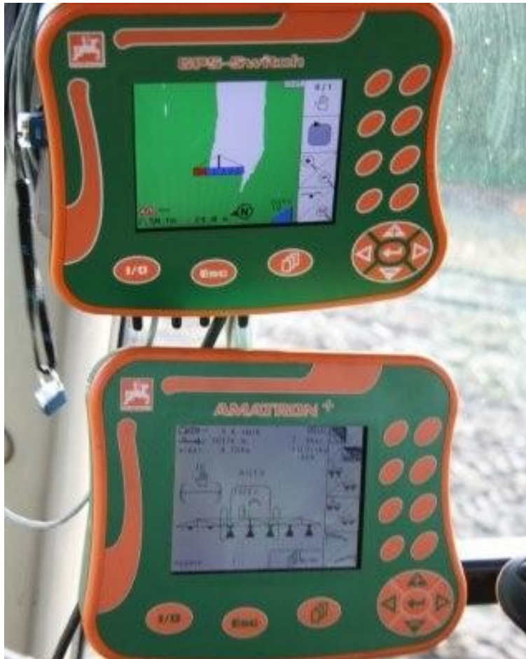
GPS Switch er i en selvstændig boks i Amazones Amatron serie. Det sprøjtede areal farves. Det markeres ikke, hvor der er sprøjtet med overlap.
