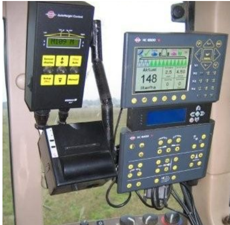
Markering af åbne og lukkede sektioner ses tydeligt på Hardy HC6500 computeren.
