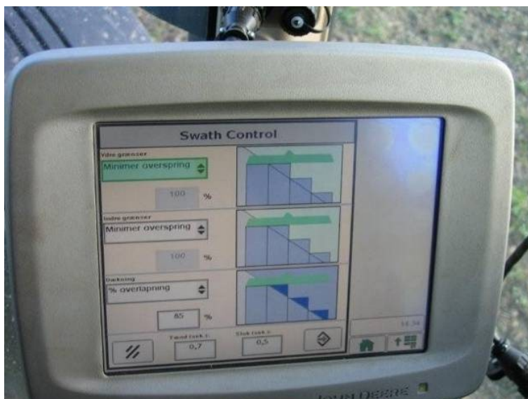
På dette skærbillede indstilles graden af overlap på Swath Control Pro fra John Deere.
