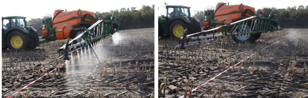
To billeder optaget lige efter hinanden viser lukning af sektioner lige ved det udlagte bånd. Fra testen af Amazones system.
