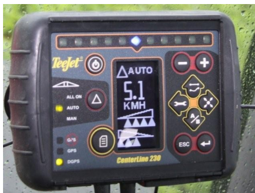
Bommen er grafisk delt på to linjer på den lille skærm. Diodebjælken øverst bruges til at give styreanvisninger.
