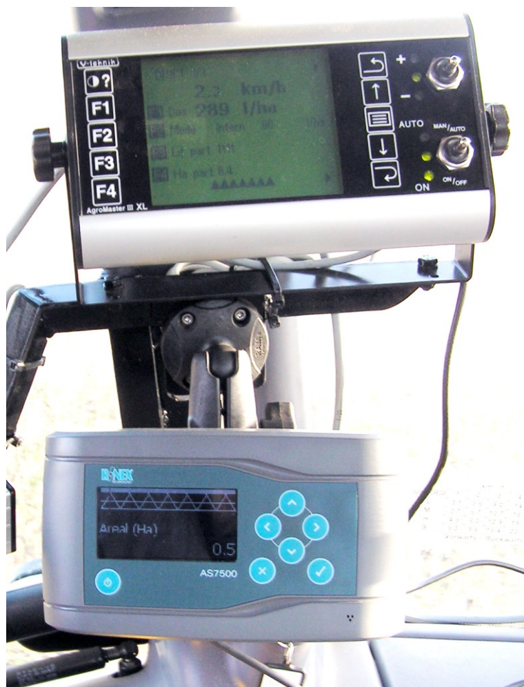
Markeringen af åbne og lukkede sektioner er ikke tydelig på AS7500 computeren. Det er bedre på ScanAgros sprøjtecomputer.
