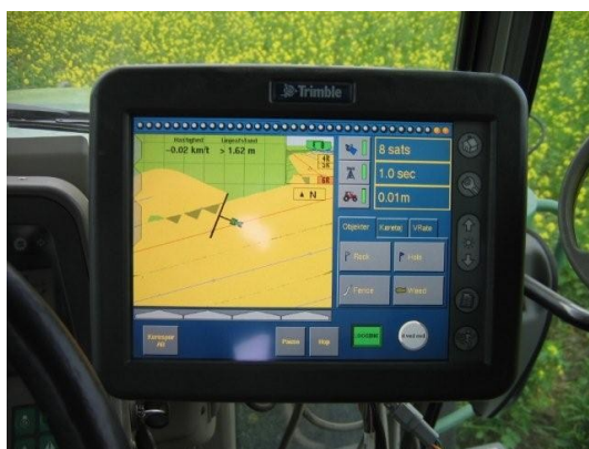
Sektionsafblænding, autostyring af traktor og markering af områder eller punkter foregår på den trykfølsomme skærm.
