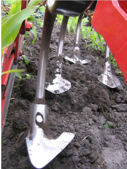
Figur 7. Skær på Einböck radrenser, der radrenser majs.
