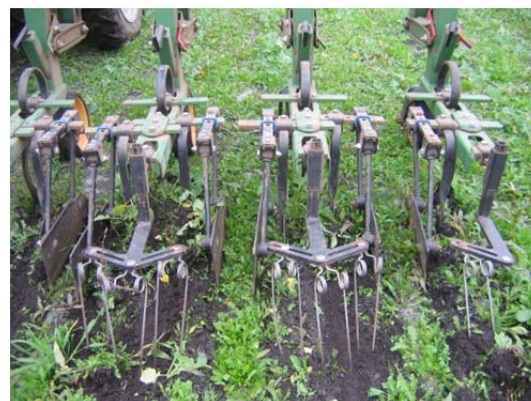
Figur 18. Total svigt i visionsstyringen. Bemærk, at rapsplanterne bliver bortrenset – midten af rensesektionerne er placeret ca. midt hen over rækkerne!
