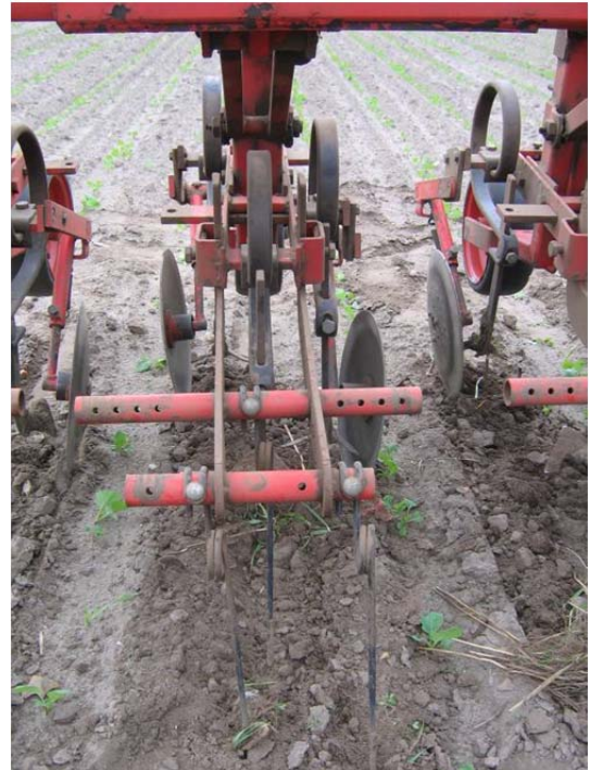
Figur 12. Bemærk de to tallerkenruller og de tre langfingerharvetænder på rensesektionen.
