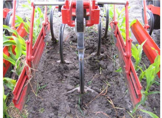
Figur 8. Skærenes placering i rensesektionen. Bemærk de to skjoldplader.
