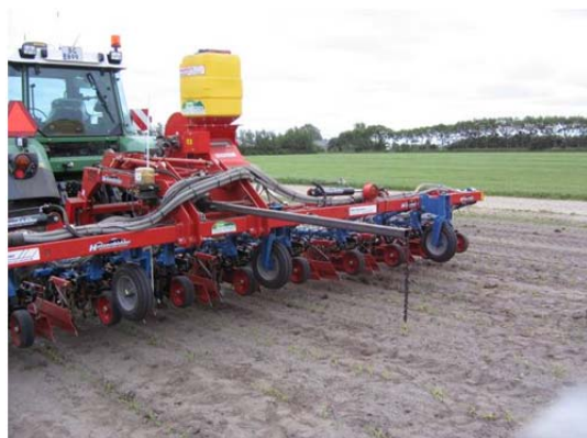
Figur 13. Hatzenbichler radrenser. Bemærk "styrestangen" foran
