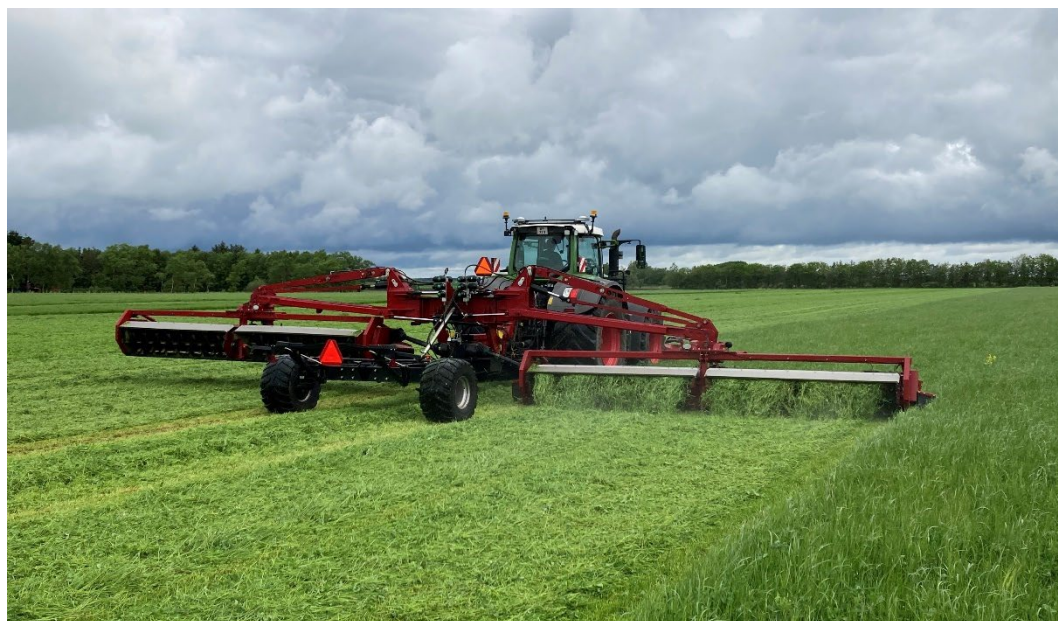
Billede 2. De ekstra spor i led 2 er lavet ved at hæve hhv. en sidefløj og frontenheden i to retninger, så samme bredde blev skårlagt med to træk i stedet for ét træk. Foto: Henning Sjørslev Lyngvig, SEGES Innovation.
