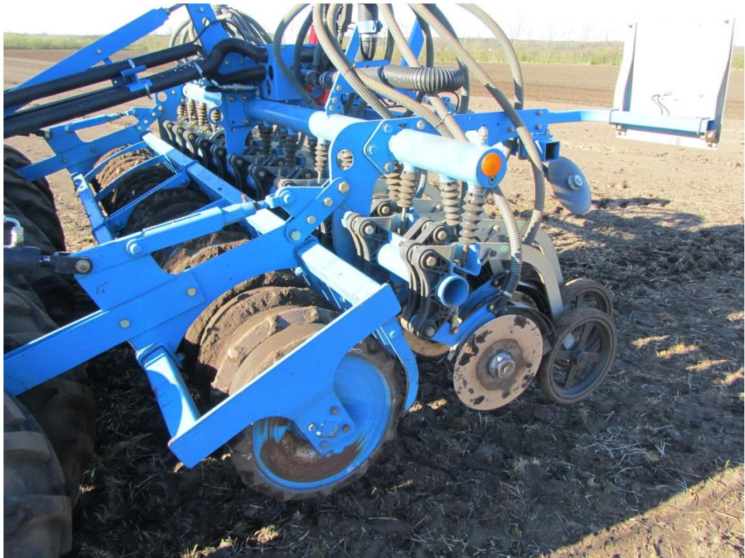
Billede 5. Stålpakvalse er monteret med stålringe, der sporer med de enkelte skiveskær, der således sår i den rende, som stålringene laver. Afstanden mellem stålringene er altid tilpasset rækkeafstanden.
