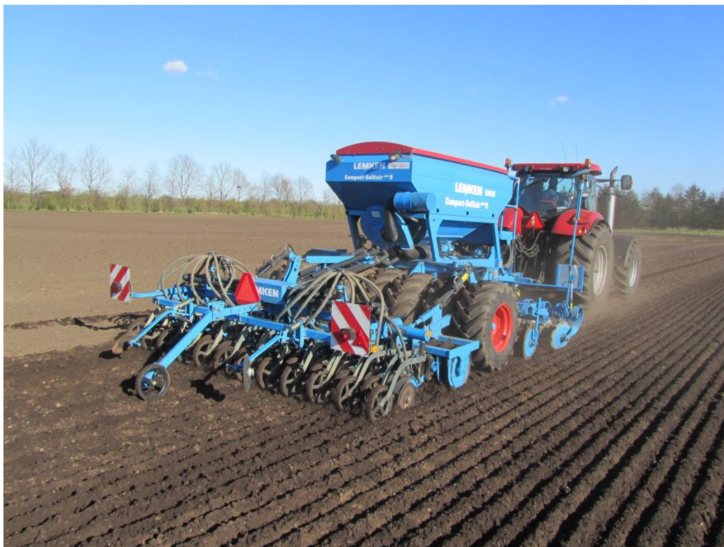
Billede 4. Stålringer på stålpakvalsen laver et spor foran hvert skiveskær. Sådybden styres af et dybdestyringshjul på hvert skiveskær og justeres ved at vinkle såsektionen.
