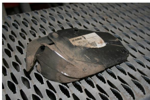
Billede 8. Græs-slæbeskæret fordeler græsset i to rækker med ca. 5,5 cm mellemrum
