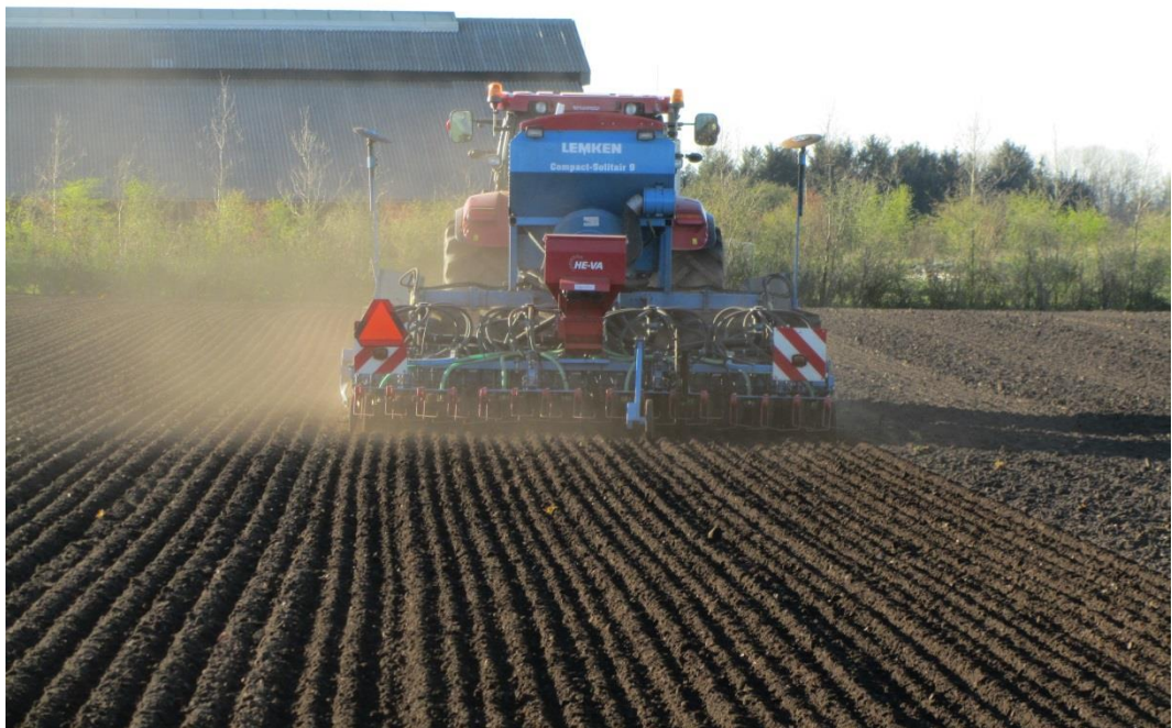
Billede 6. Der sås altid i bunden af den rende, som stålringene på stålpakvalse laver.
