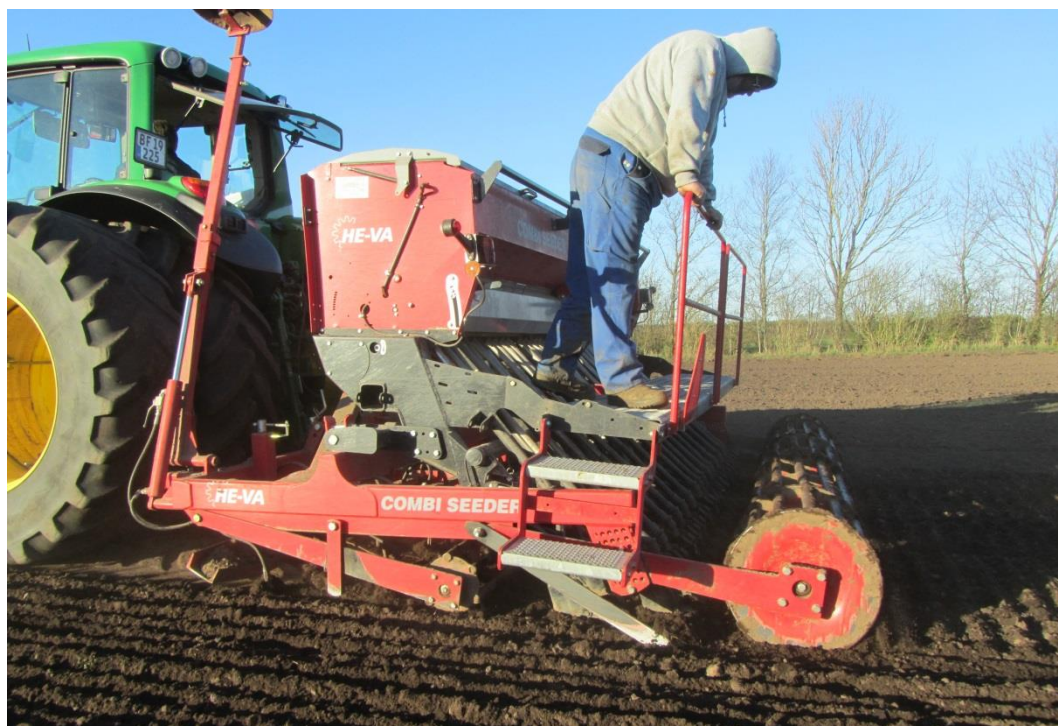
Billede 7. HE-VA Combi Seeder kan monteres med specielle græs-slæbeskær, der reducerer rækkeafstanden væsentligt.
