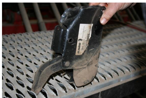
Billede 8. Græs-slæbeskæret fordeler græsset i to rækker med ca. 5,5 cm mellemrum
