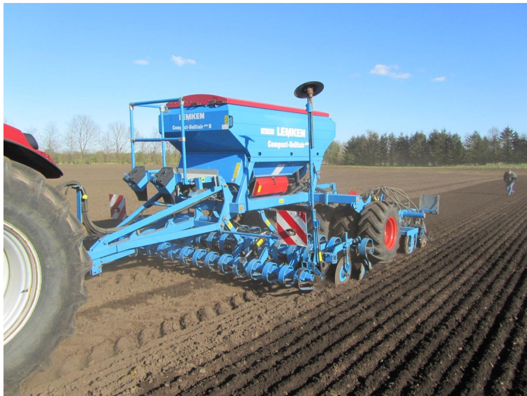
Billede 3. Lemken Compact Solitair bearbejder jorden med en tallerkensektion før såning.
