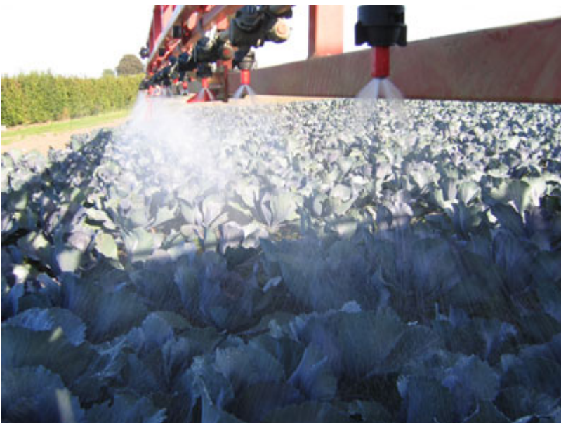
Figur 5: Her ses en dobbelt luftinjektionsdyse fra Arag, TFA110-04. Det ses tydeligt, at de meget grove dråber bedre holder retningen end dråberne fra dobbelt refleksdyse.
