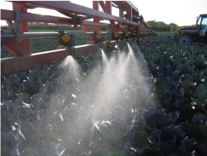
Figur 4: Dobbelt refleksdyse ISO-størrelse 06. Sprøjtewæsken er mere samlet ved denne dyse, da dråberne er større end ved 04 dysen. Dråberne holder bedre retningen mod planterne og afdriftsrisikoen er dermed mindre.
