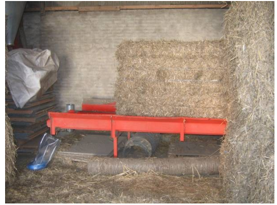
Halmbane med opriver. Snorene klippes ikke på bagerste bigballe.
