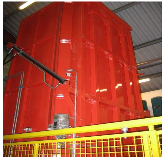
Halmen cigar-indfyres stykvis fra bunden af bigballen, som er tippet op inde i kassen.
