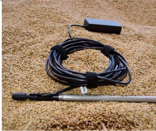
Figur 6. Stackview trådløs temperatursensor. Der er kabel mellem spyddet og senderen.
