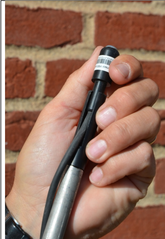
Figur 4. Stackview sensor gøres klar til placering i kornstak.
