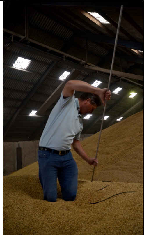
Figur 5. Stackview sensor stikkes ned i korndyngge ved hjælp af "harpun" (lang, slank metalstang).
