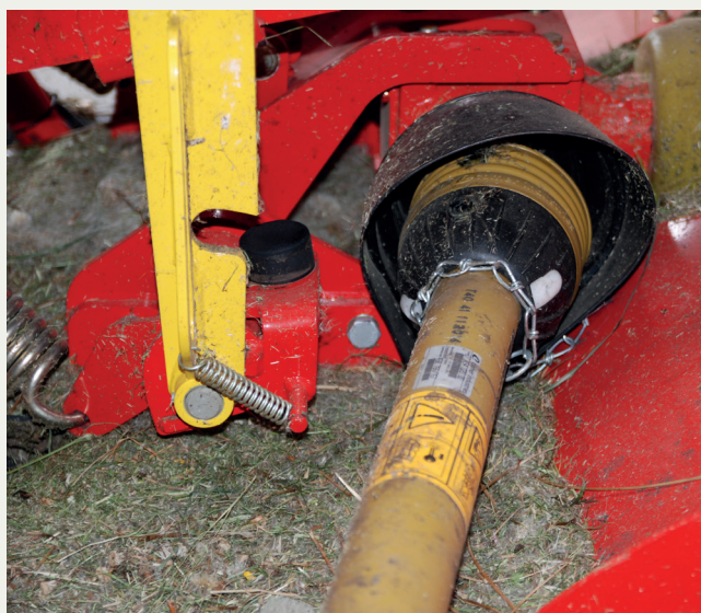
Forsøg på at rette på afskærmningen uden at standse kraftoverføringen kan gå grueligt galt.
