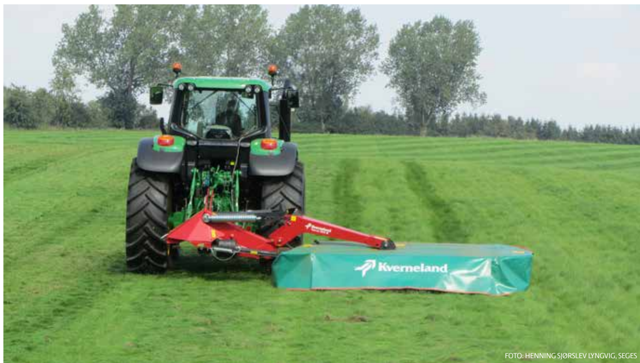
BILLEDE 8 Den anvendte skiveslåmaskine var en Kverneland 2832 M
