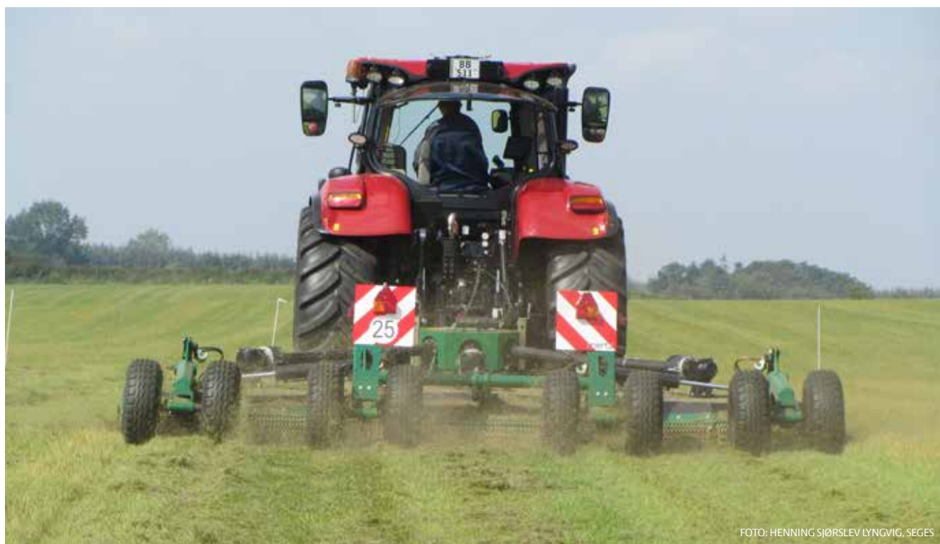
BILLEDE 2 Den anvendte rotorklipper var en Spearhead Stubble Master 500.
