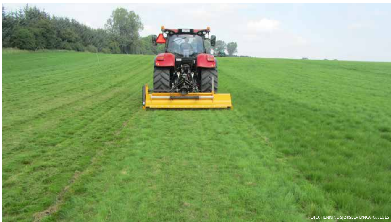
BILLEDE 5 Den anvendte rotorklipper var en Müthing MU-M Vario 300
