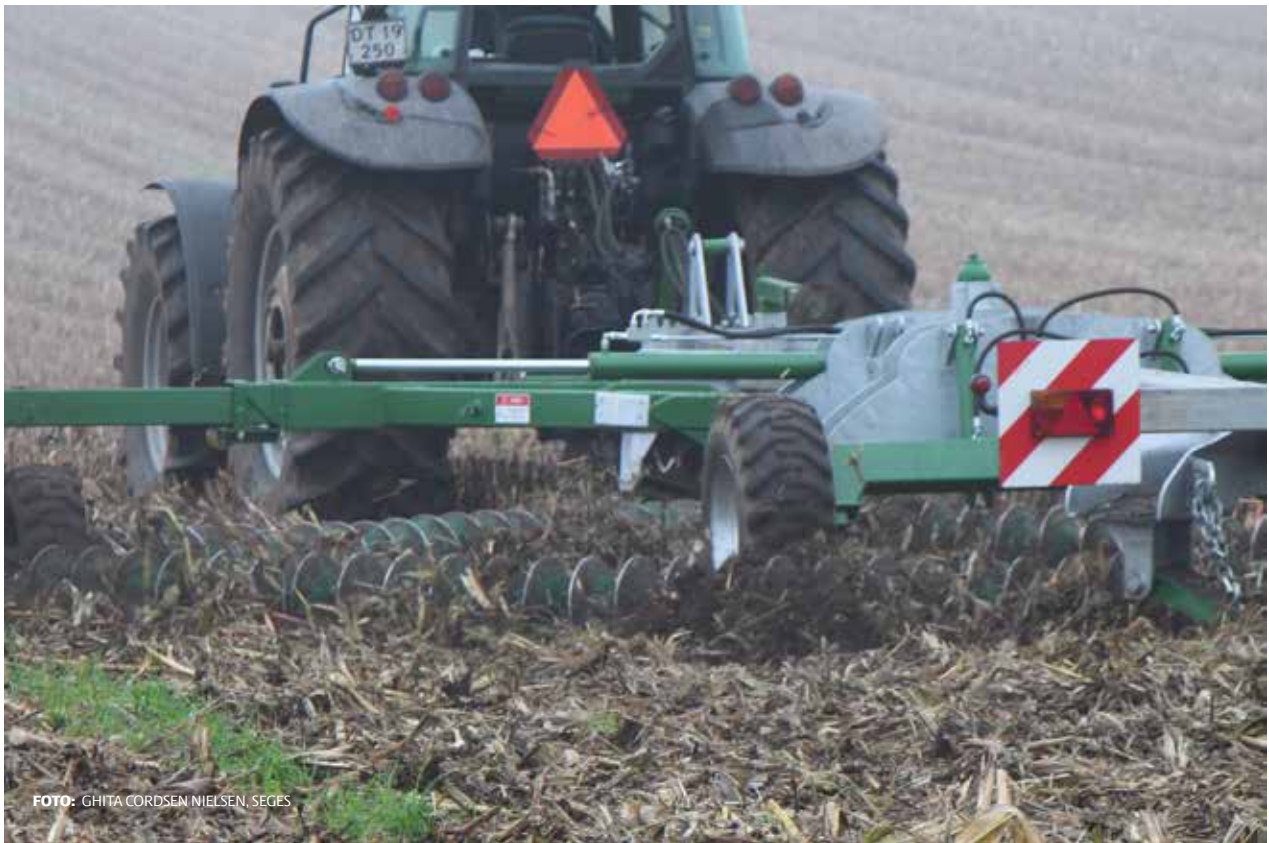
Billede 25. Tallerkenharve med små tallerkner (kædeharve) i majsstub efter kolbemajs.
