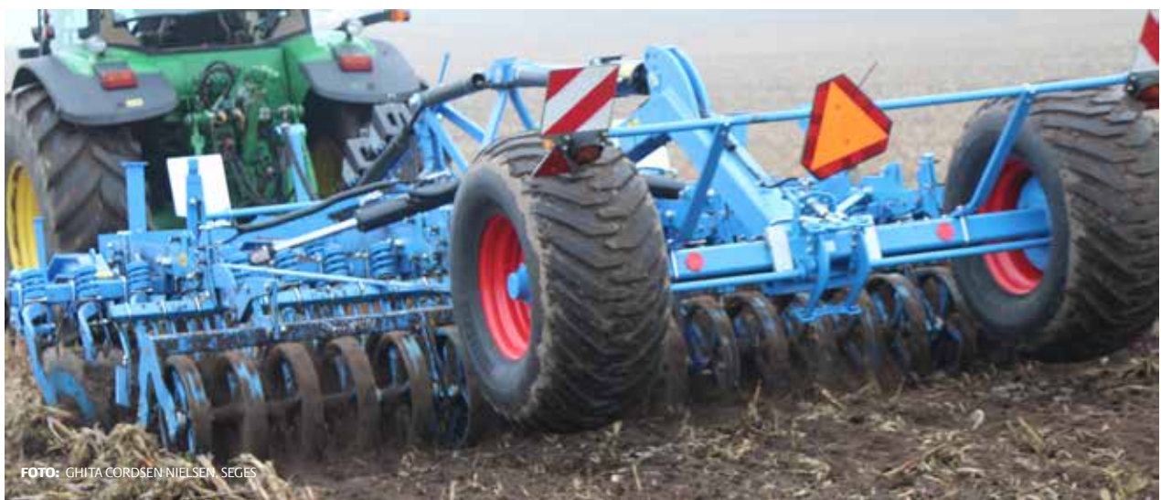
Billede 30. Dobbelt DPW pakker, der laver jord til jord pakning og trykker stænglerne i nogen grad.
