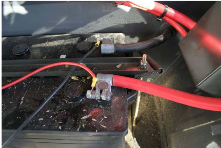
Figur 11. Strømmen til sprederne kan tages direkte fra traktorens eller mejetærskerens batteri. Husk at montere 15-25 Amp. sikring på +ledningen.
