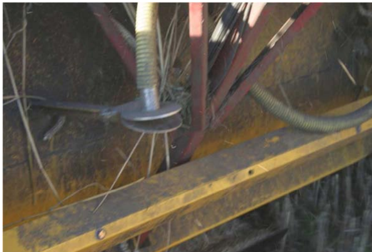
Figur 18. Prelleplade for enden af slangerne til spredning af frø fra en luftspreder.
