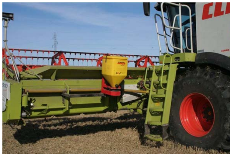
Figur 16. Sprederne monteres på et specialbeslag på hver side af skærebordet.
