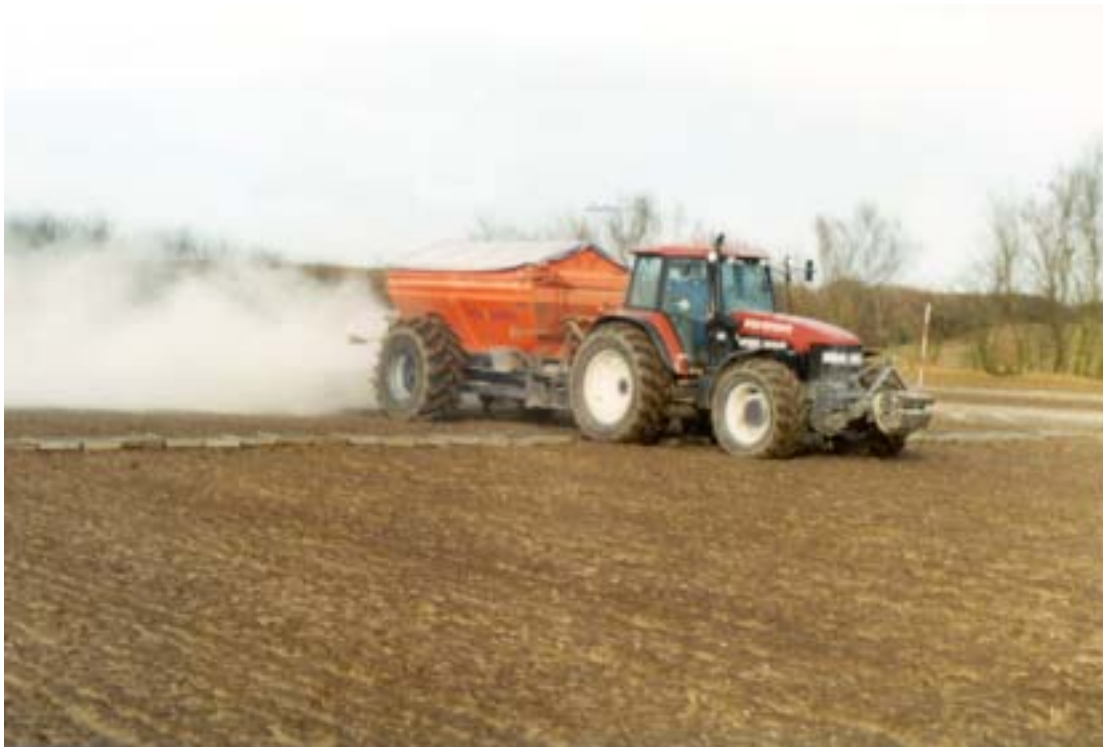
Spredebakker placeret "side om side" til måling af spredenhøjagtighed på tværs af kørselsretningen.
