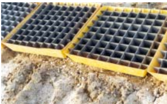
En del kalkklumper blev opfanget af bakkernes kant. Derfor er det med spredebakken ikke er muligt at måle den eksakte udbragte mængde, men alene forholdet mellem doseringen i de enkelte bakker.
