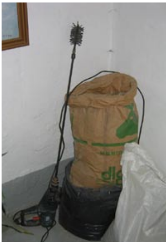
Boremaskine med børste anvendes til rengøring af konvektionsrørene.
