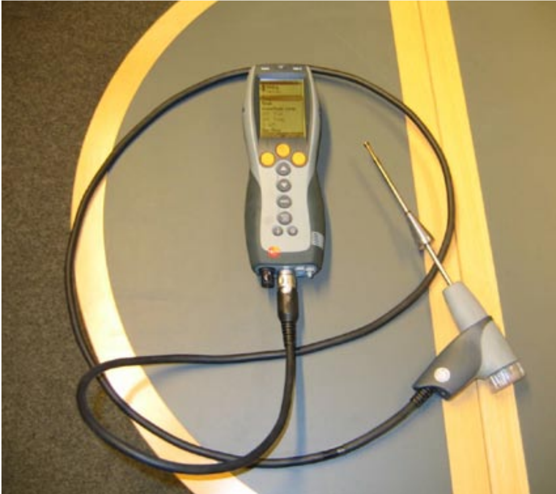
Røggasmåler Testo 330-2 anvendt til måling af røggastemperatur.
