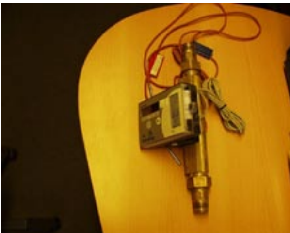
Kamstrup varmemåler, nominelt flow på 6 m 3 pr. h.
