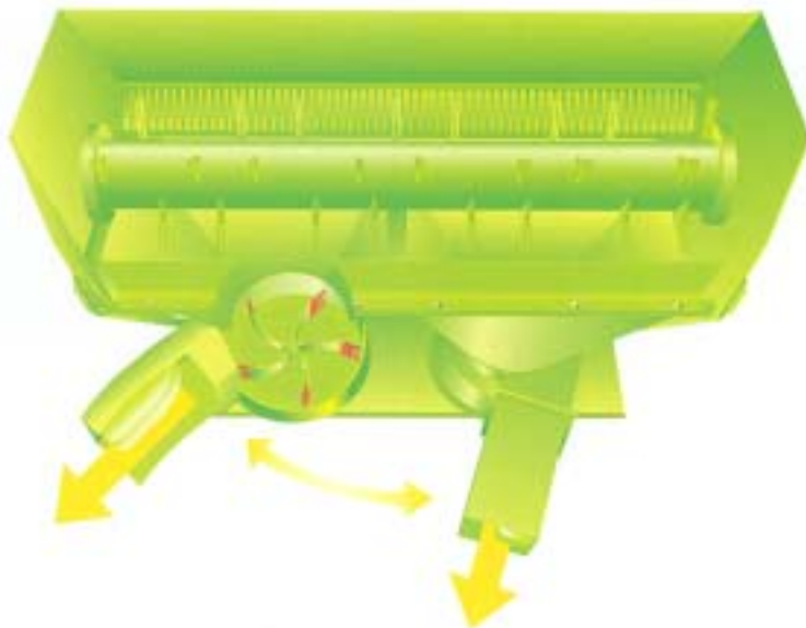
Figur 3. Principskitse af snitter og blæsere.
