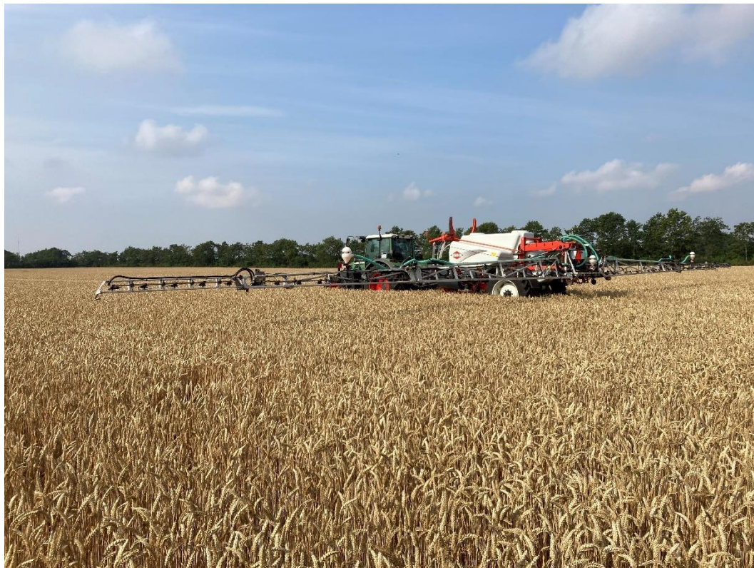
Billede 1. Det eftermonterede spredeudstyr på en 30 meter sprøjtebom. Foto: Henning Sjørslev Lyngvig.
