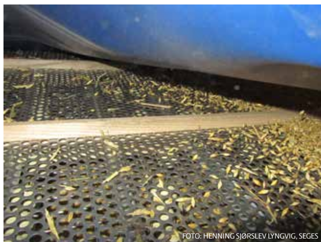
BILLEDE 6 Skumsoldet lader kornet passere, mens halm og aksdele rystes mod soldets ende.
