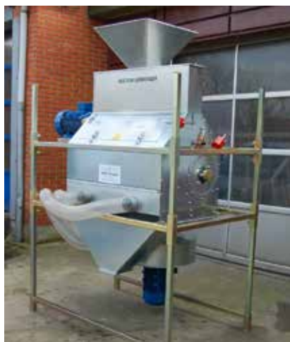
BILLEDE 14 Til højre ses balancevægten, der styrer hvor lang tid afgrøden bearbejdes af kørneren. www.vestjysk-smede.dk
