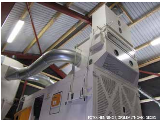
BILLEDE 4 Sug ved indgangen af renseren, fjerner de helt lette partikler før afgrøden når soldarealerne. Ved finrensning er der ofte monteret sug ved afgang soldareal.
