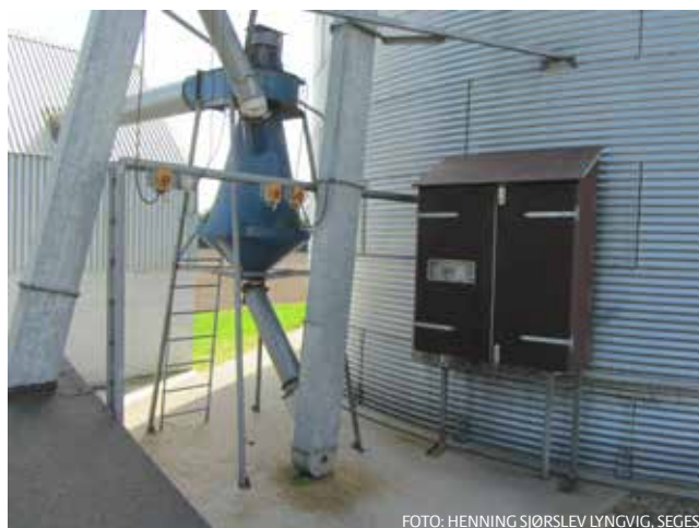
BILLEDE 12 Aspiratør monteret mellem elevatoren fra korngraven og elevatoren til redleren i toppen.
