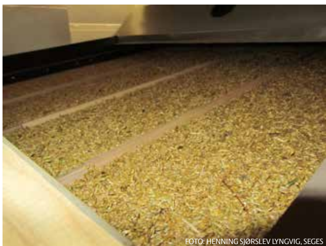
BILLEDE 5 Sandsoldet lader kun partikler mindre end kornet passere. Kornet rystes mod enden.
