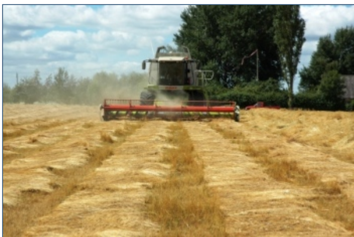
Med det almindelige bord blev der tærsket 4 skår ad gangen. Hastigheden var 1,5 km/t.
