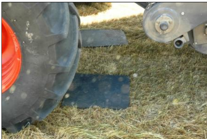
Måling af spild fra mejetærsker
