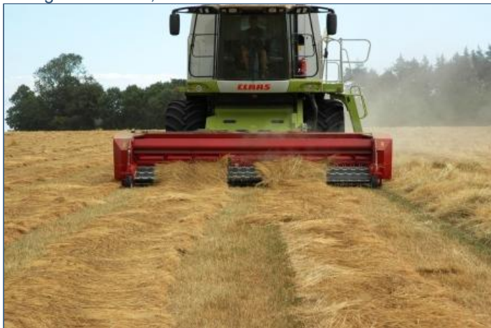
Med pickupbordet blev der tærsket 2 skår ad gangen. Hastigheden var 3,0 km/t.
