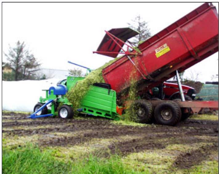
Læsses der for hurtigt af, opstår der spild ved indlægningen. Der er efter billedet er taget sat ekstra sider på AG-BAG maskinen for at forhindre spild under hurtig aflæsning.
