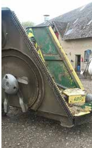
BILLEDE 4 Brakpudseren fra Spearhead med en bredde på 6,20 meter
