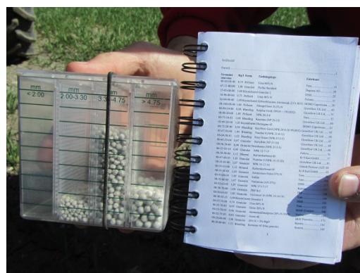
Billede 10. Indstilling foretages i forhold til aflæsning i manualen, på baggrund af en rysteprove.
