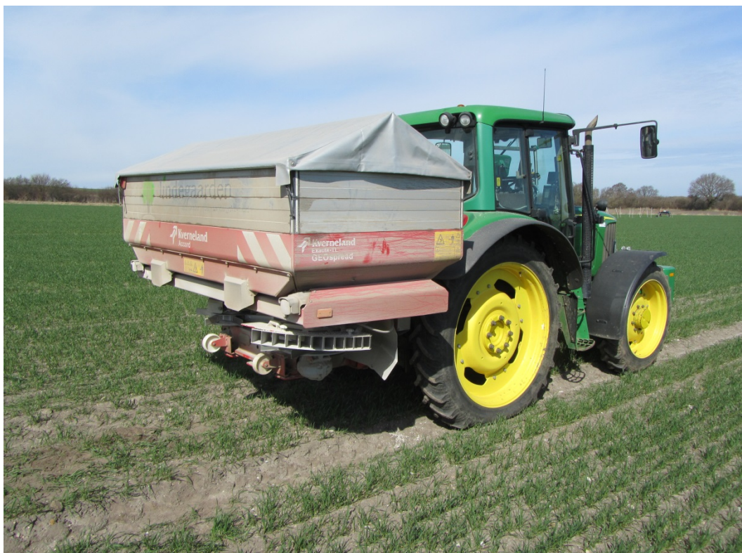
Billede 8. Kverneland Accord Exacta TL GEOspread. Afskærmningen til kantspredning sænkes hydraulisk.
