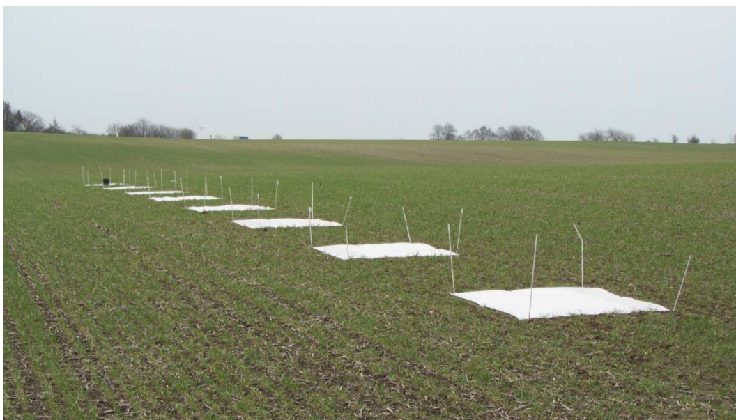
Billede 2. Afdækning af referenceparcellerne under tildeling af gødning med centrifugalsprederen. Gødningstildeling i parcellerne blev foretaget med en forsøgsspreder.
