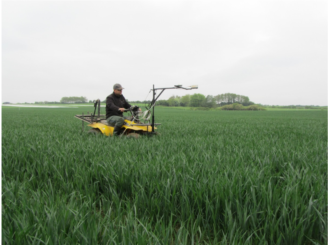
Billede 3. RVI-skanning med Crop Circle med Geo-positioneringsudstyr monteret på en ATV.
