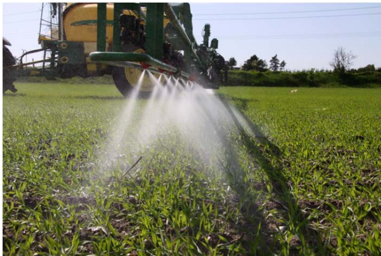
Figur 8. Hi-Speed dysen vinkler sprøjtevæsken 10 grader frem og 50 grader tilbage i forhold til kørselsretningen.
