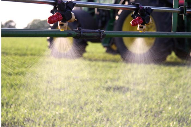
Figur 5. Lavdriftdyse ISO 02 ved 3 bar.
