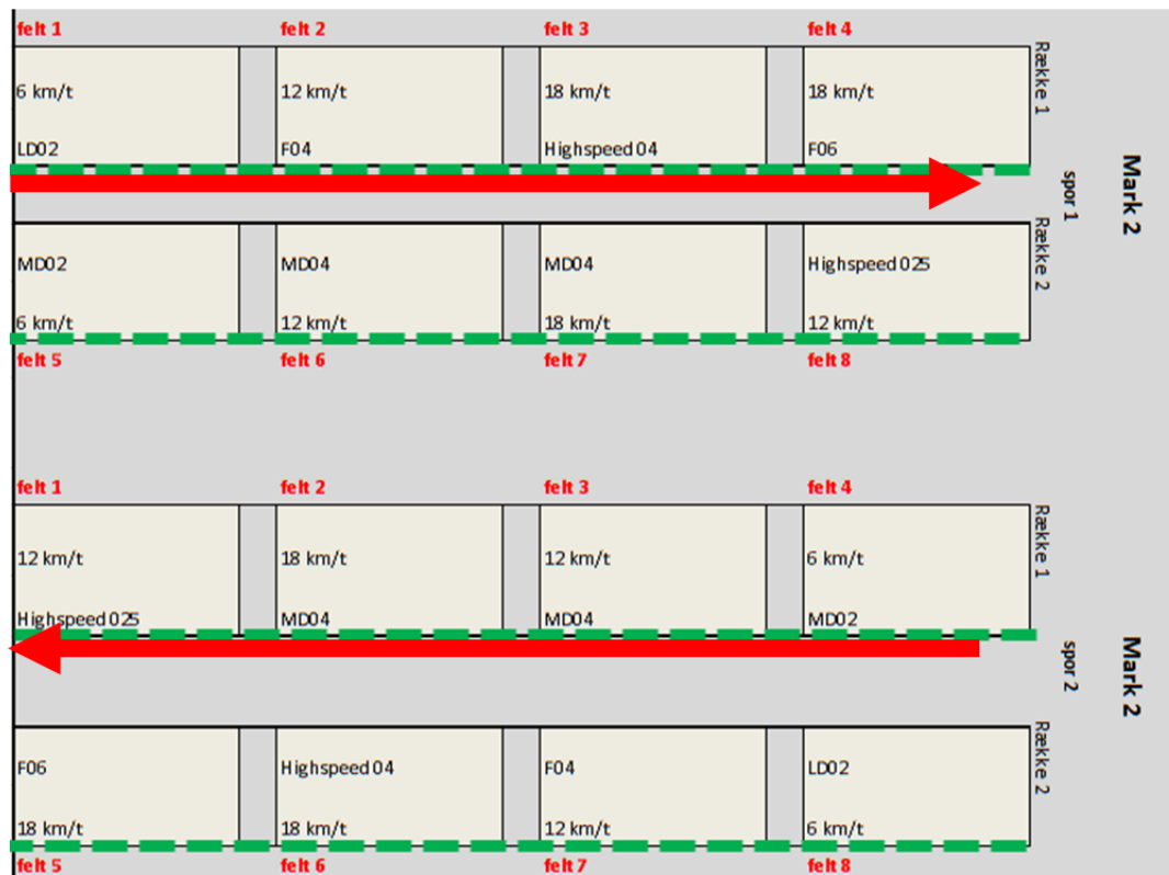
Figur 1. Her ses en forsøgsplan, hvor otte behandlinger gentages i to sprøjtespor men i hver sin retning (de røde pile), for at udligne vindpåvirkning.
