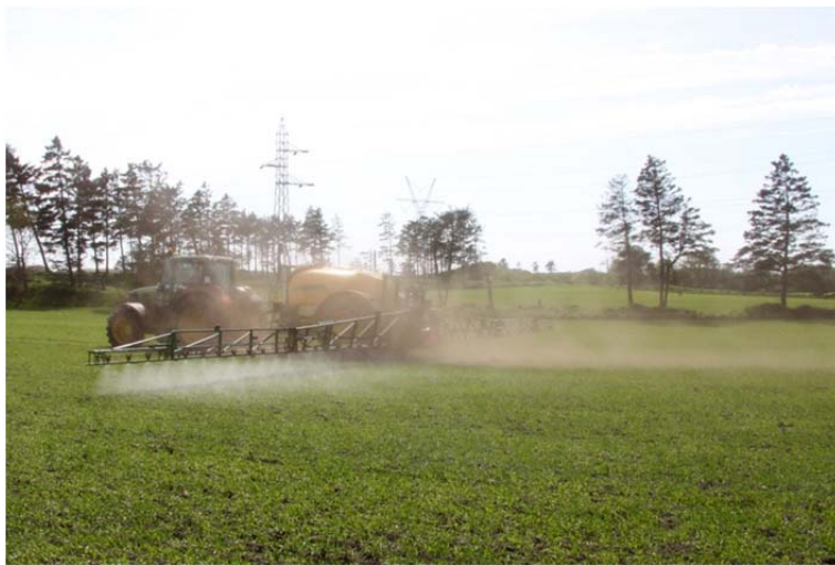
Figur 13. Her sprøjtes der med 18 km/t, ved denne hastighed er risikoen stor for at ophvirvle jordstøv, som det tydeligt ses på billedet.
