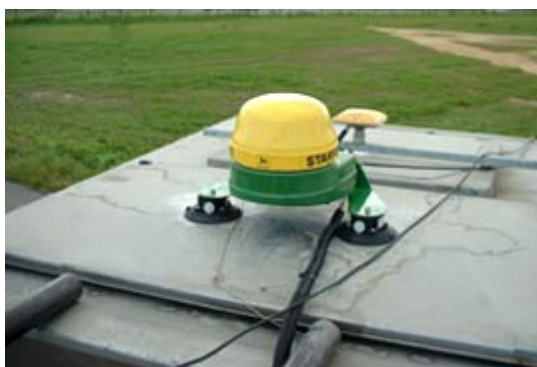
Midt på traktorens tag sad forrest på skift de GPS-antennener, der blev benyttet af guidancesystemerne. Bag denne sad RTK-GPS-antennen, der fastlægger traktorens position med få centimeters nøjagtighed.
