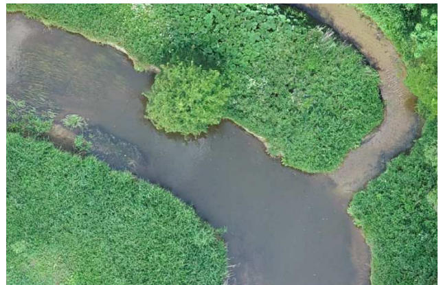
Figur 37. Lokalitet 2 taget i svinget hvor et andet større tilløb fra nord kommer til. Grøden ses i venstre side af billedet, og vanddybden anes at øges nedstrøms med størst uddybning i ydersiden af svinget, hvor tilløbet med tydelig sandbund strømmer ud i hovedløbet.
