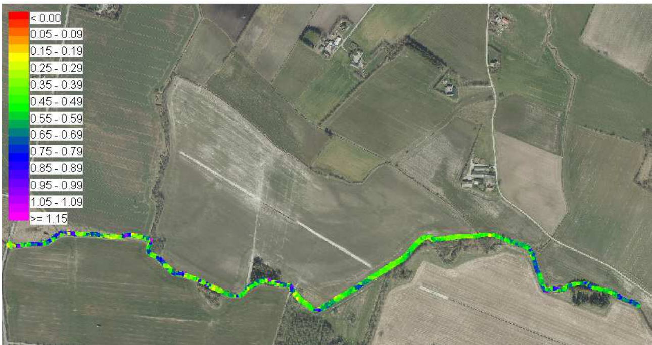
Figur 11. Dybdemålinger foretaget den 17.april 2020 med M9 båddronen. Skala er 0 til 1 meter. Lilla værdier angiver dybder på 1 meter og derover. I vandløbets vestlige del, første halvdel af strækningen, ses en del dybdevariation, der afløses af en mere plan bund på den næste fjerdedel for derefter at variere igen på den sidste del af strækningen.
