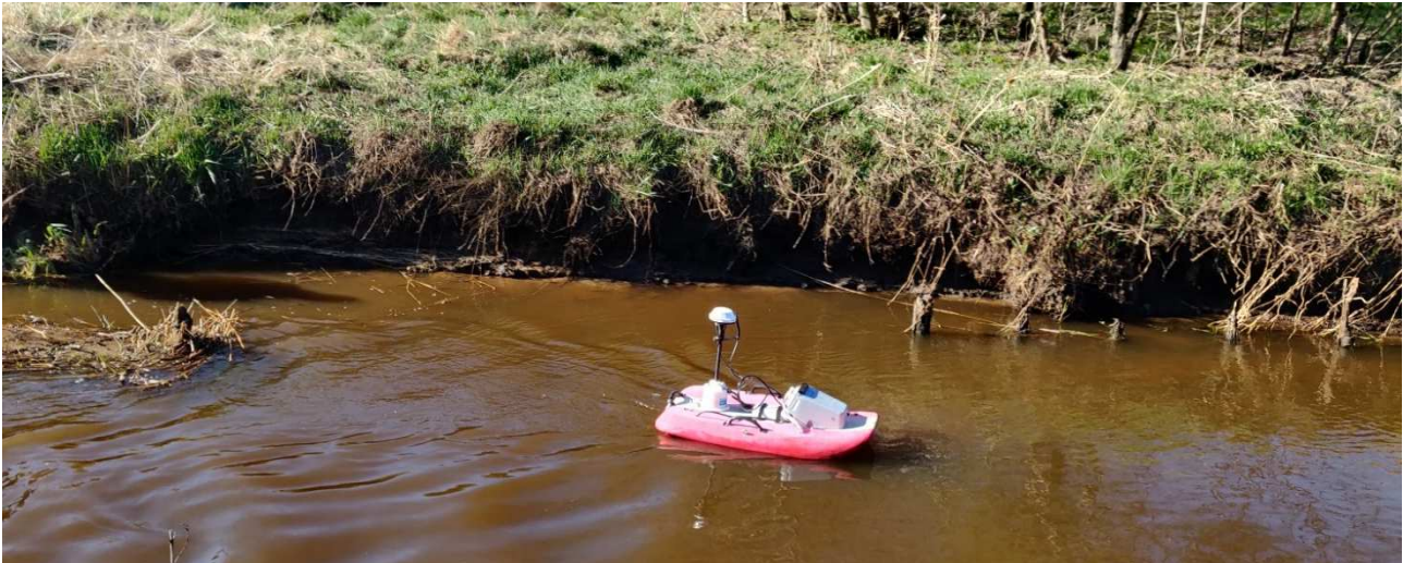
Figur 8. Opmåling med Sontek M9 i Gerå den 17. april 2020.
