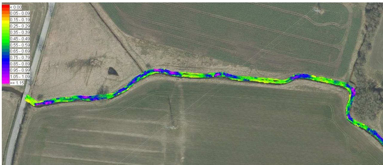
Figur 47. Bådronneopmåling af st. 0-460. På denne strækning er der udtaget bundkoter fra opmålingen for hver 3 meter.
