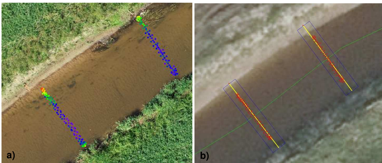
Figur 18. a) Opmålte punkter for tværprofiler i st. 1191 og st. 1200. Bemærk at vandstanden på opmålingsdagen med båddronen var lavere, end vandstanden var på dagen, hvor luftfotoet er taget. Derfor dækker de opmålte punkter ikke hele det vanddækkede profil. Det er således nødvendigt med en tilstrækkelig vanddybde, for at de lavvandede områder langs kanten bliver beskrevet ved båddronens opmåling. b) Generering af tværprofil ud fra de opmålte punkter.
